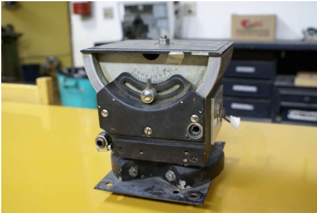
Figura 4 - cabeça para suporte de câmera
