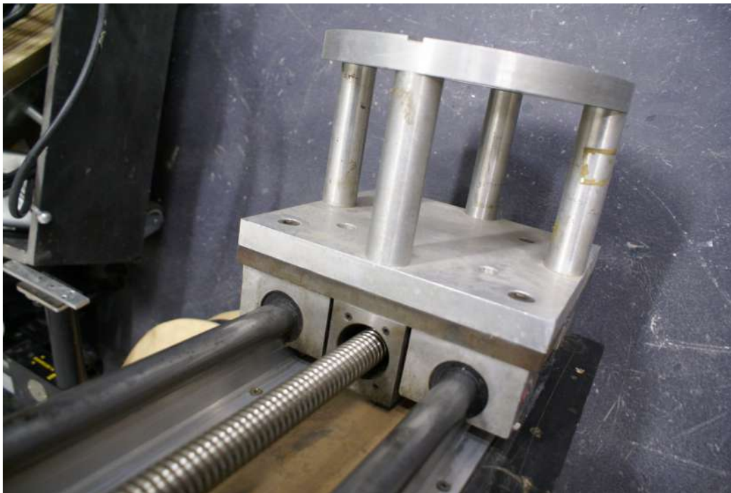
Figura 7 - fuso com castanha de esferas
