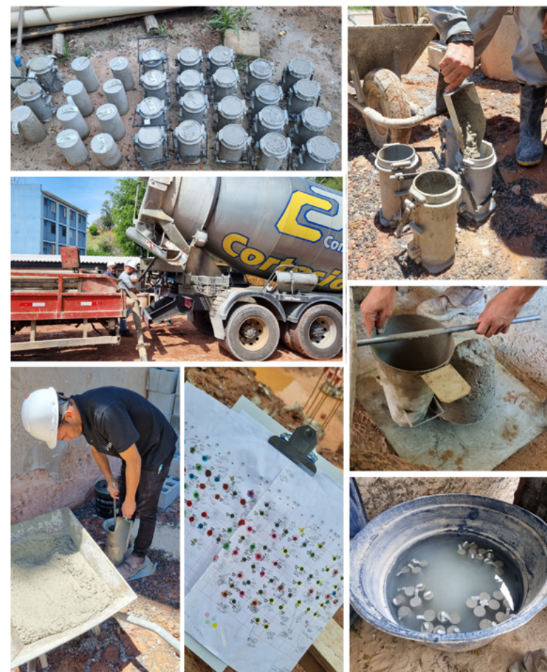
Figura 21: Montagem de fotos - controle tecnológico de concreto. Fonte: Acervo da autora, 2023.
