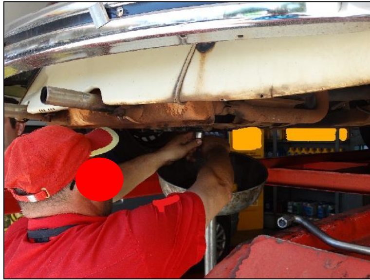
Figura 28 – Trabalhador realizando a troca de óleo de um veículo
