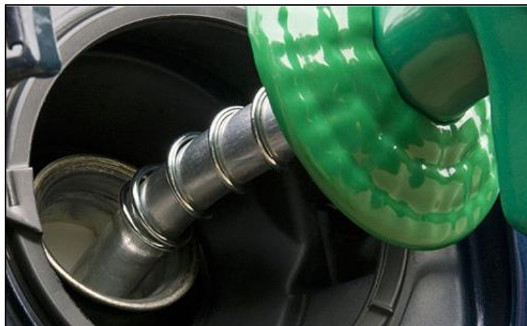
Figura 18 – Protetores para respingos e extravasamentos nos bicos durante o abastecimento (rodilhas)
