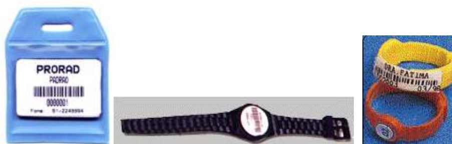
Figura 5. Exemplo de dosímetros termoluminescentes (para pendurar próximo ao tronco, de pulso e anel, na respectiva ordem). (16)
