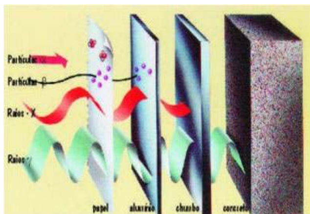
Figura 2. As quatro radiações mais ionizantes e o poder de penetração de cada uma. (7)
