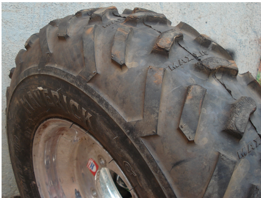
Figura 21 – Pneu trativo Maxxis usado nas rodas traseiras do protótipo 2006
