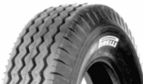
Figura 18 – Pneu direcional multiraiado (Fonte: PIRELLI)
