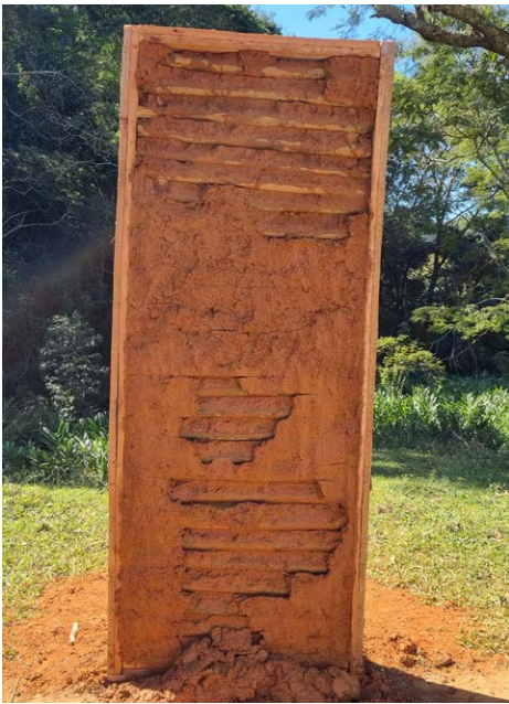
Fig. 48. Protótipo do painel, queda do barro após a primeira aplicação. Fonte: acervo do autor.
