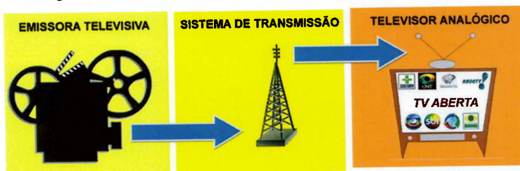
Figura 2 – Sistema de radiodifusão para TV Analógica.
