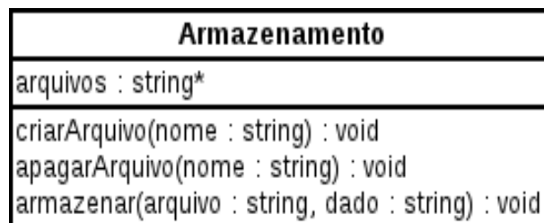
Figura 10 - Diagrama com atributos e métodos da interface Armazenamento
