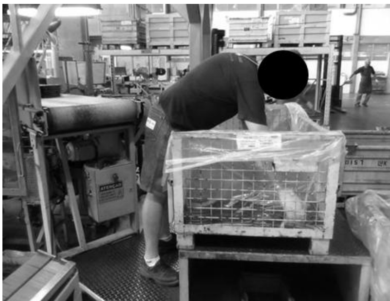
Figura - 17 Alimentação de placa de pressão na linha de montagem
