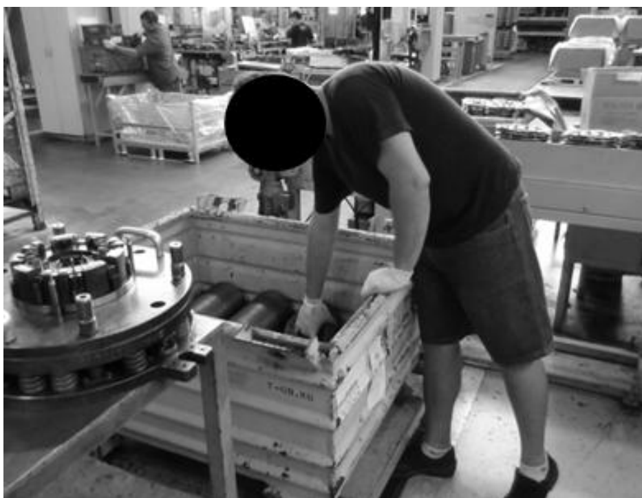
Figura 16 - Alimentação de mola membrana na linha de montagem
