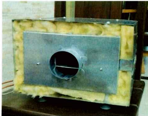
Figura 20: Camada isolante de lã de vidro
