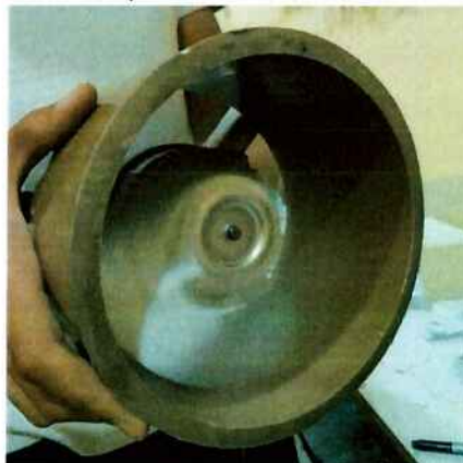
Figura 16: Exaustor dentro do suporte de PVC em funcionamento
