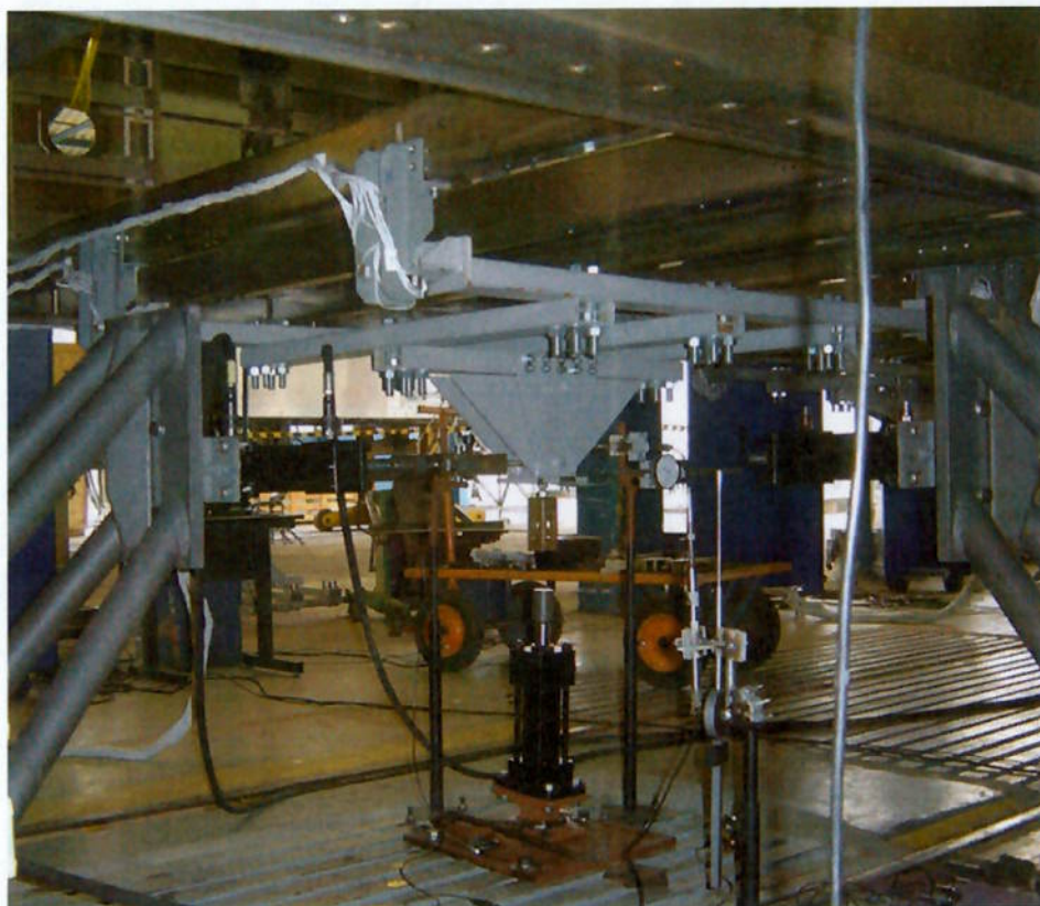
Figura 11 - Arranjo para aplicação da carga
