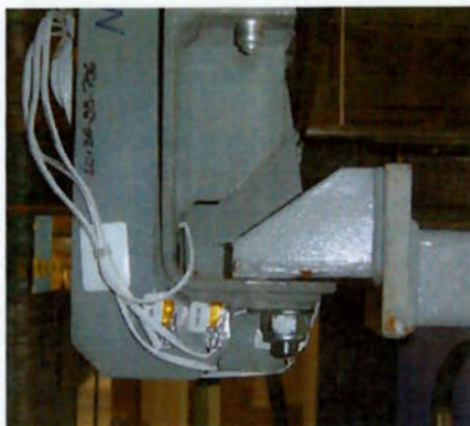
Figura 32 – Ligação do suporte ao “jig” de aplicação de carga
