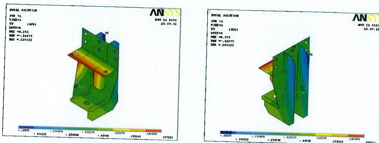
Figura 47 – Deslocamentos na direção transversal (Y) para o suporte N-1
