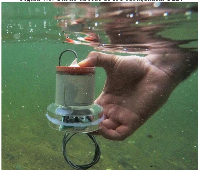
Figura 4.6: Um nó da rede de IoT subaquática, U2B.
