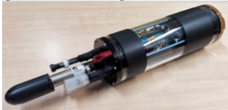
Figura 4.14: Pacote de sensores inteligentes de baixo custo ( SwanNode ).
