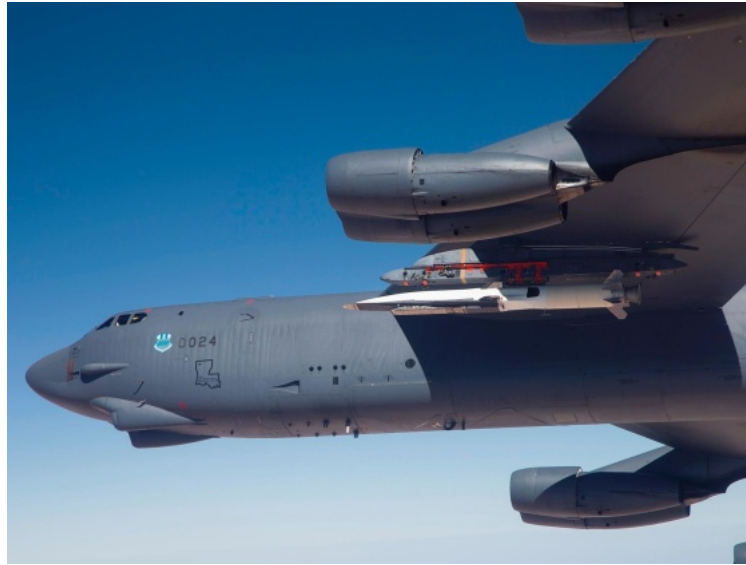
Figura 4 – Demonstrador Tecnológico X-51 acoplado à Aeronave B-52. Fonte: Adaptado de (BOYLE, 2013) e (MOSES et al., 2004).
