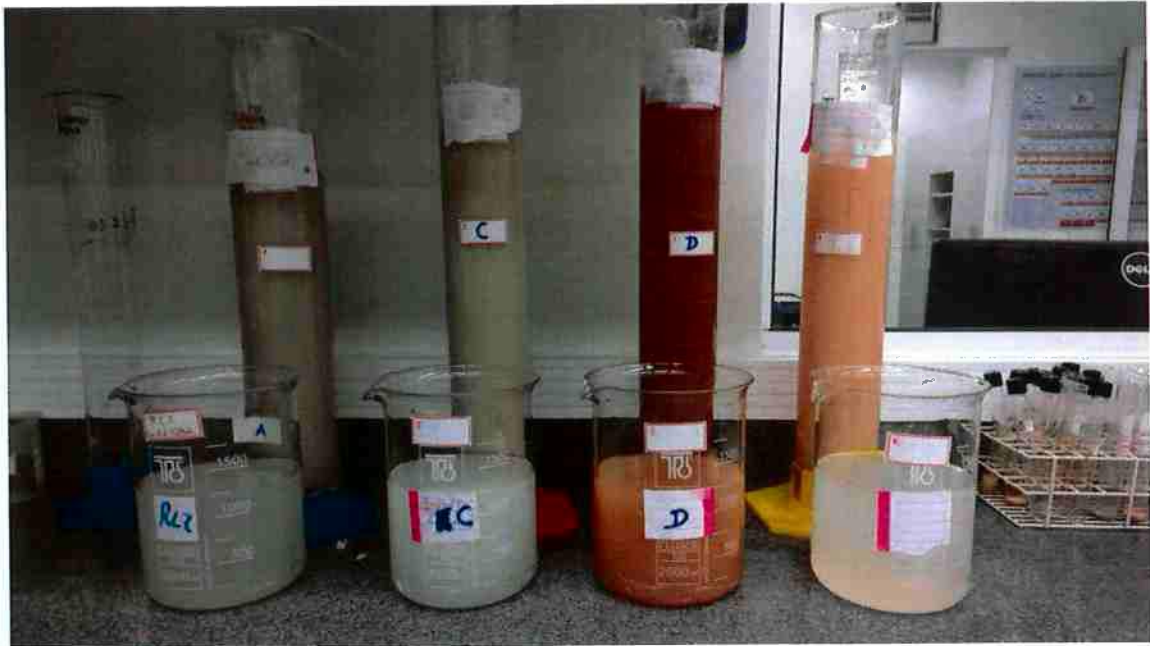
Figura 7. Fotografia das amostras sob processo de sedimentação, realizado no laboratório do PMI
