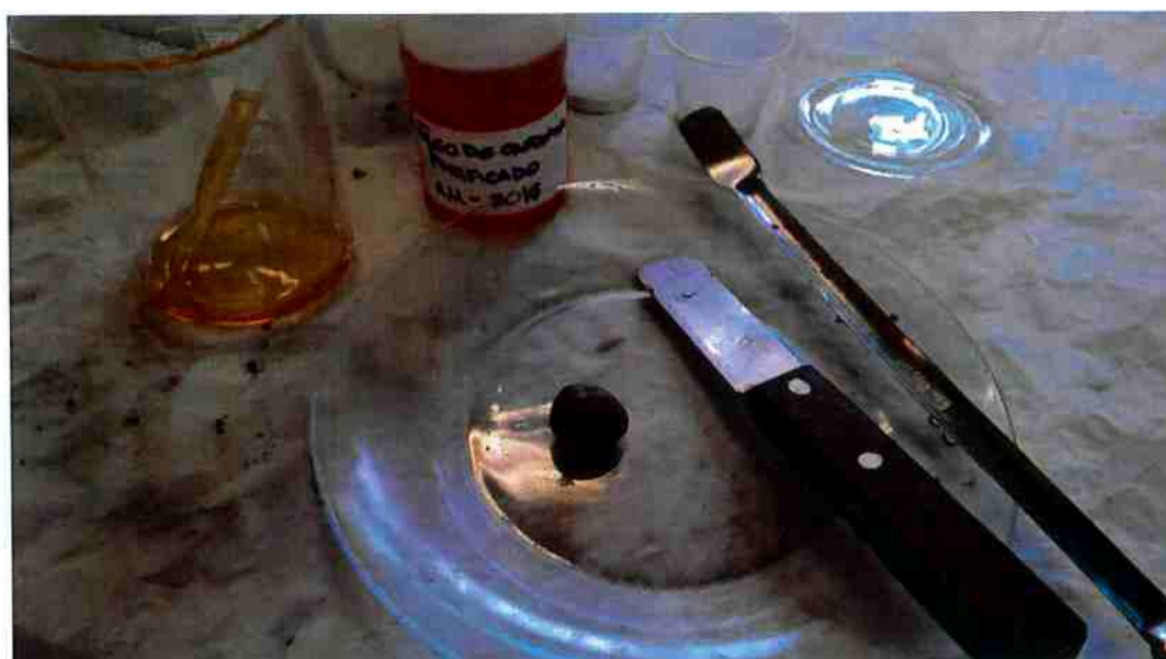
Figura 21. Formação da esfera de argila após a adição máxima de óleo.
