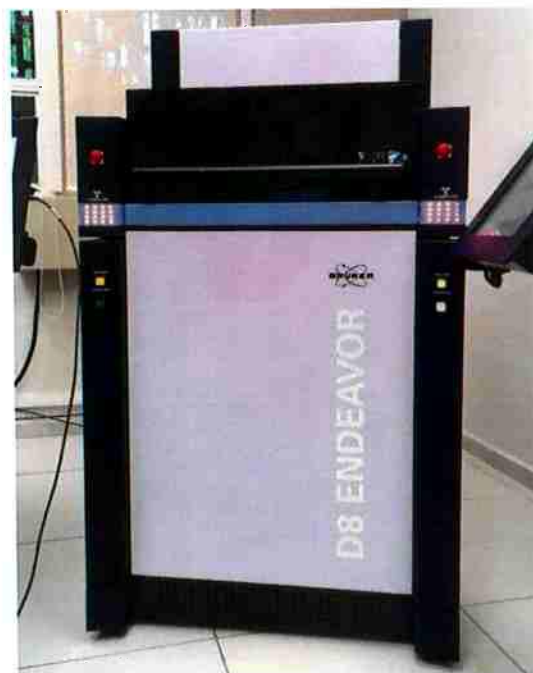
Figura 8. Aparelho Bruker - D8 Endeavor: utilizado para caracterização das argilas
