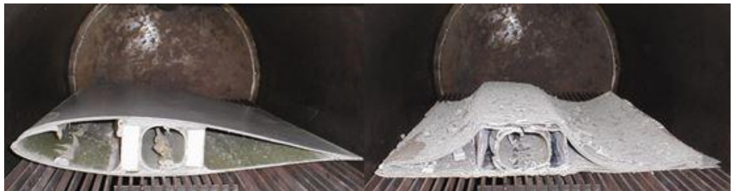
Figura 3 - Lâmina de turbina eólica antes e depois da pirólise
