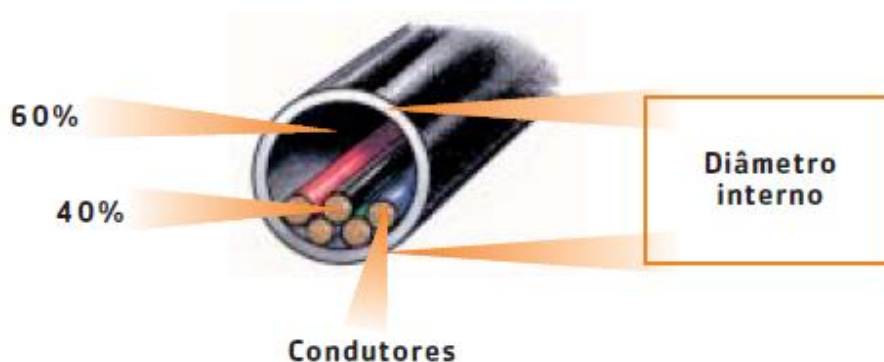
Figura 68 – Representação de um eletroduto e seus condutores Fonte: Manual da Prysmian
