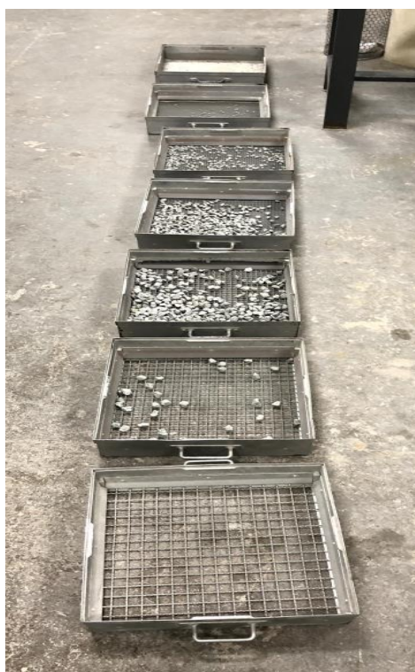
Foto 10 - Peneiras com agregado graúdo (Brita 1 Granítica).
