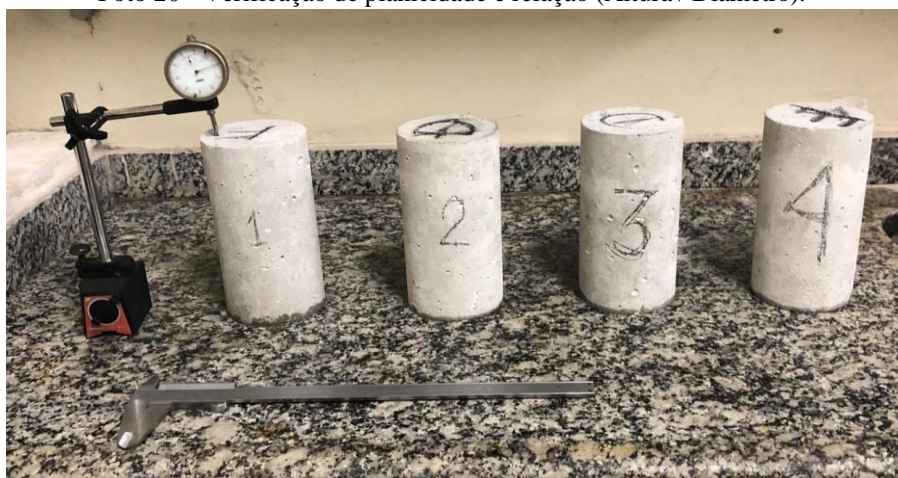
Foto 20 - Verificação de planicidade e relação (Altura / Diâmetro).
