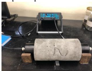
Foto 22 – Corpos de prova em ensaio de ultrassom
