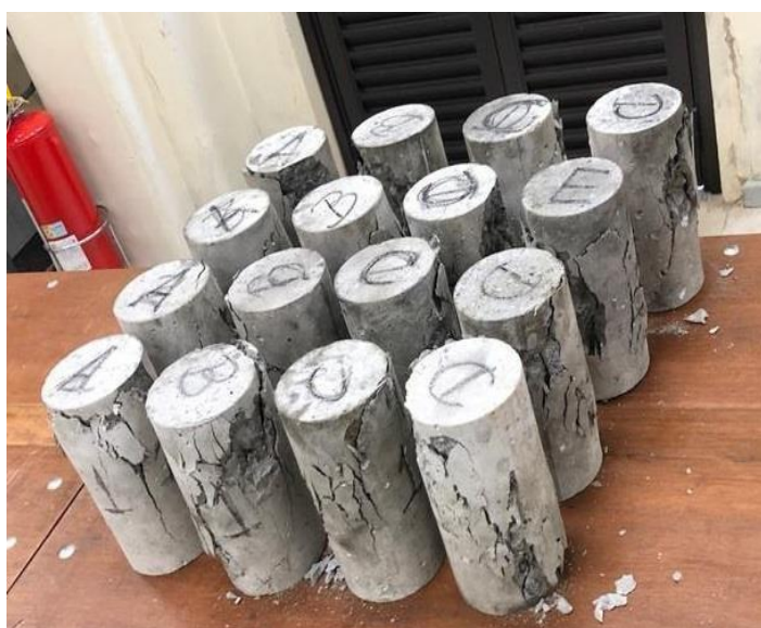
Foto 25 - Corpos de prova após ensaio de compressão axial.
