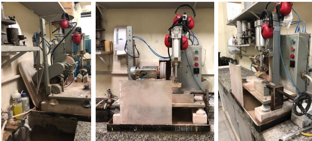
Foto 19 - Retífica cilíndrica para corpos de prova de concreto.
