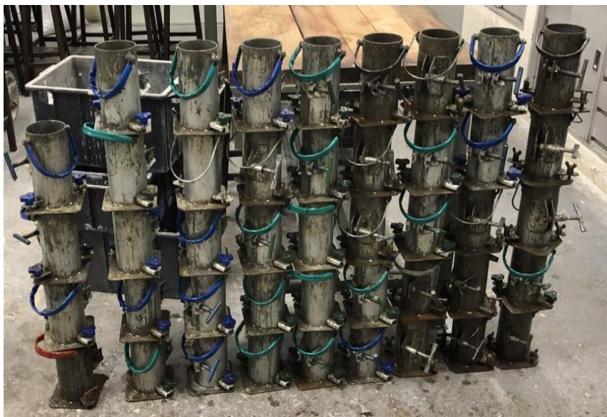
Foto 16 - Moldes para corpos de prova de 200 x 100 milímetros.
