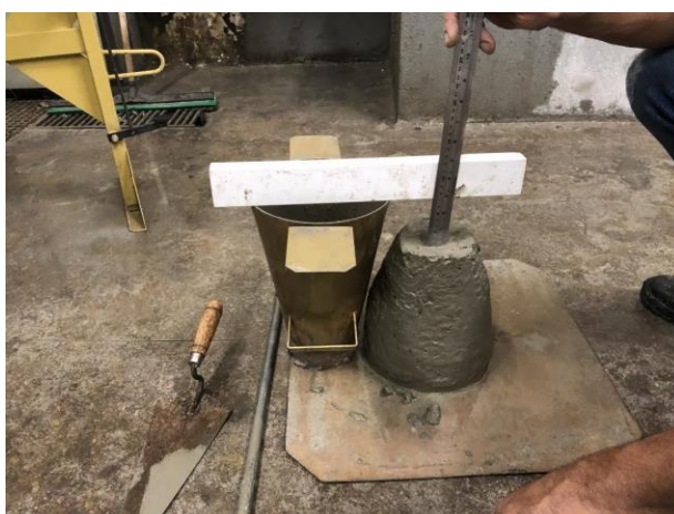
Figura 10 - Ensaio de abatimento do tronco cone (Slump Test).
