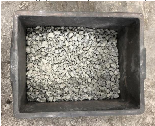
Foto 4- Agregado Graúdo (Brita 1 Granfítica).
