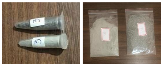
Foto 31 - Corpos de prova da amostra GR0,5% para ensaio de DRX.
