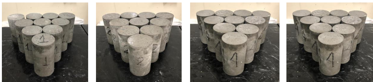
Foto 21 – Corpos de prova com faces retificadas.
