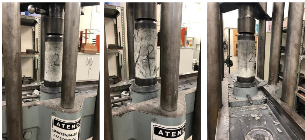
Foto 24 - Corpos de prova em ensaio de compressão axial.
