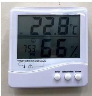
Foto 14 - Condições de temperatura e umidade na determinação de massa específica do concreto.
