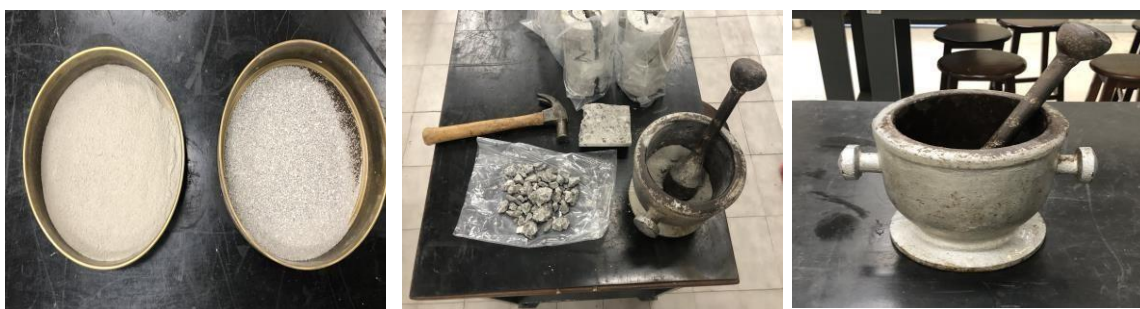
Foto 30 - Corpos de prova da amostra GR0,5% moídos e peneirados para DRX.
