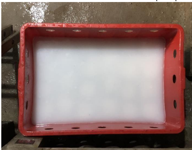
Foto 18 - Cura submersa em hidróxido de cálcio dos corpos de prova.
