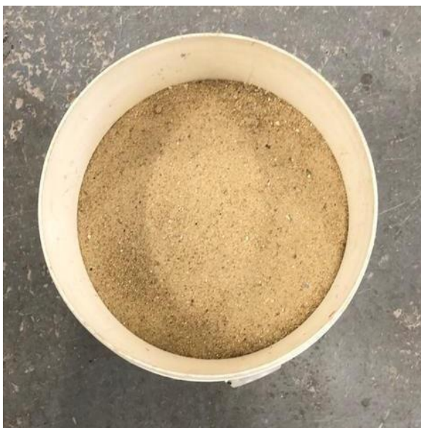
Foto 3 - Agregado Miúdo (Areia média).
