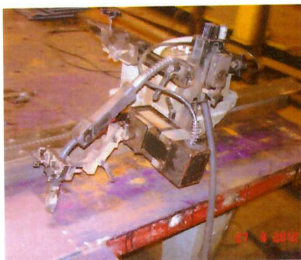
Figura 4.4 – Tocha seca manual adaptada para soldagem automática usada no experimento.
