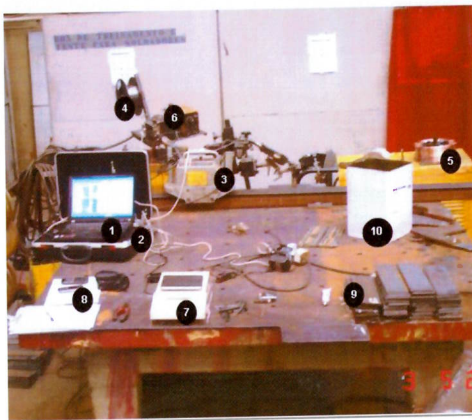
Figura 4.1 – Foto da bancada do experimento com todos os equipamentos montados. Legenda: 1 Notebook; 2 Sistema de Aquisição de Dados de Soldagem – IMC; 3 Sistema de deslocamento linear; 4 Arame tubular E71T-1C; 5 Arame sólido ER70S-6; 6 Alimentador de arame e fonte de energia; 7 Balança de precisão; 8 Cronômetro; 9 Metal base; 10 Água para resfriamento da peça
