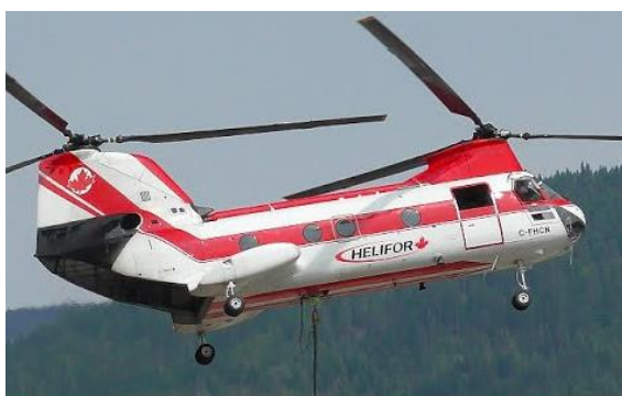
[c] Boeing-Vertol 107 – dos rotores en tándem
