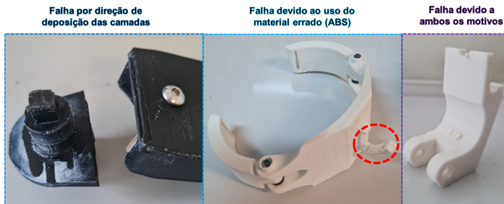
Figura 65 – Exemplo de falhas em peças durante a manufatura do projeto
