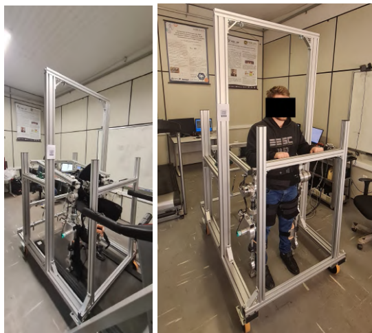
Figura 17 – Montagem final do Andador com o Exo
