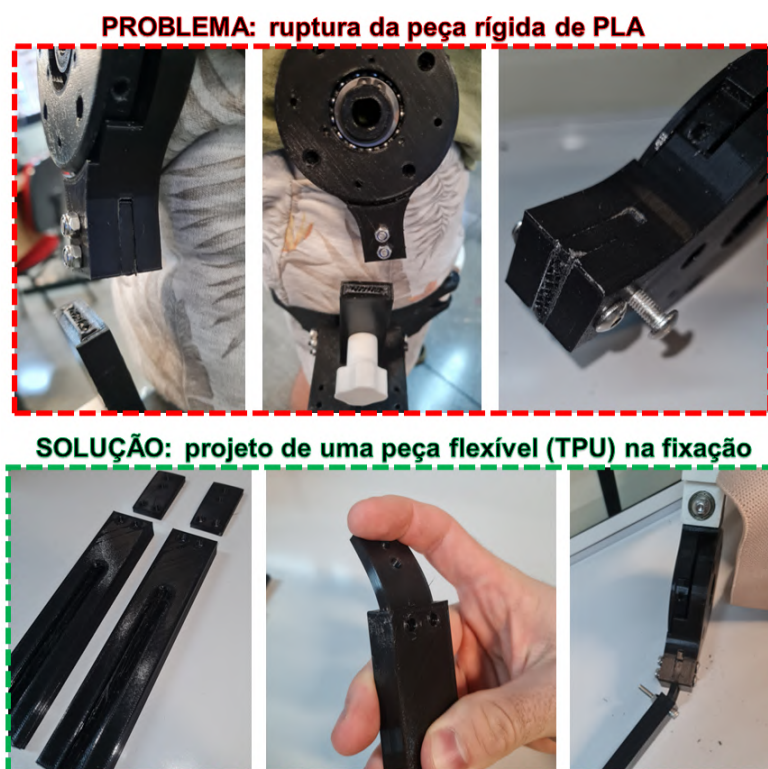
Figura 71 – Solução flexível para problema de ruptura na peça do quadril
