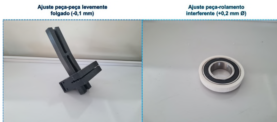
Figura 66 – Teste de ajustes para determinação das dimensões de folga e interferência
