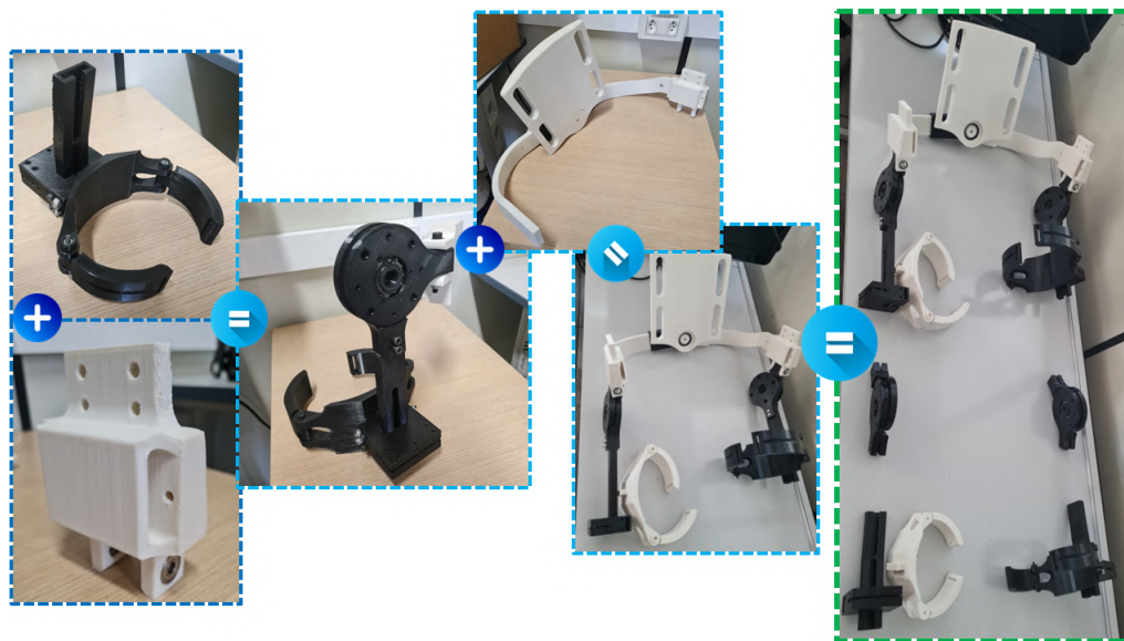
Figura 67 – Processo de montagem das peças impressas em 3D do exoesqueleto
