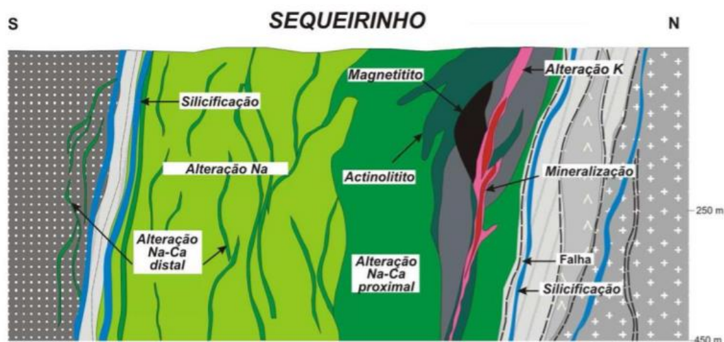
Figura 6: Perfil esquemático mostrando o modelo conceitual das zonas de alteração do corpo de minério Sequeirinho. Fonte: modificado, Monteiro et. al. (2008a)
