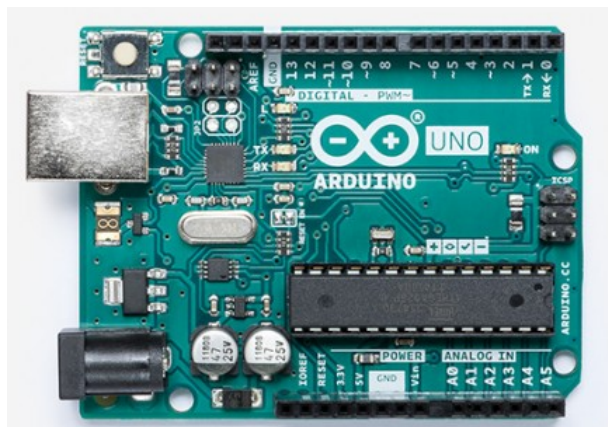
Figura 22 – Placa com módulo Arduino UNO
