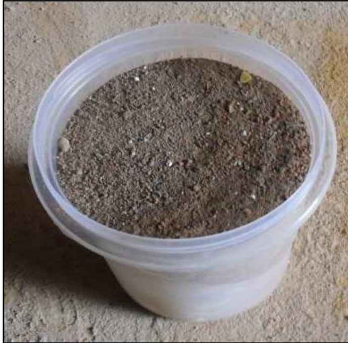
Fotografia 15: Detalhe do agregado reciclado.
