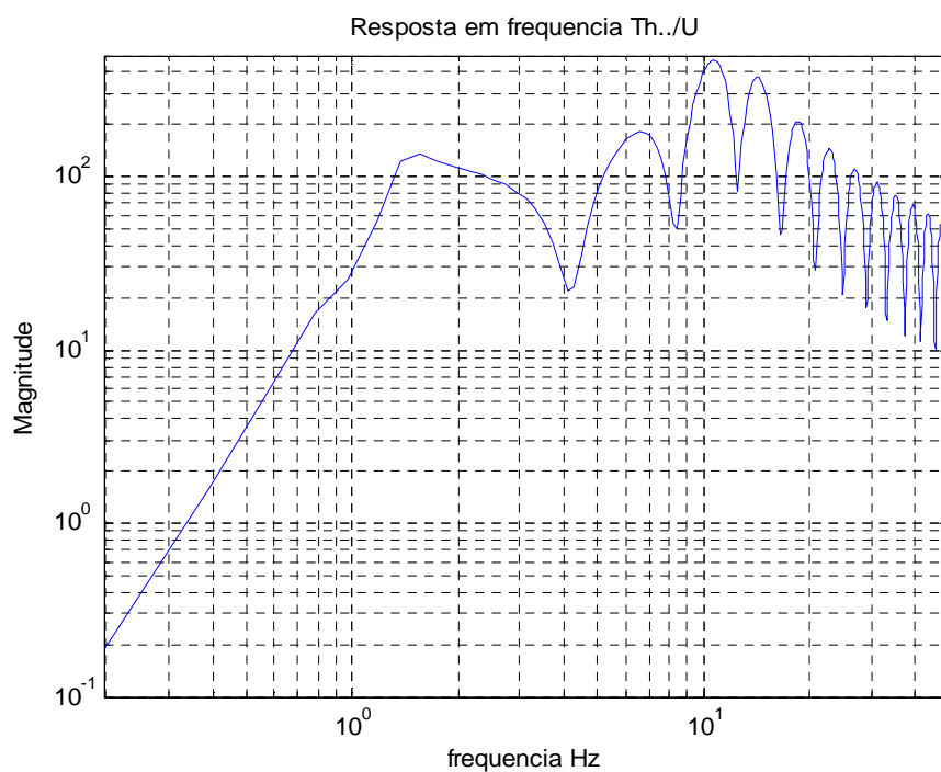
Figura 25: Resposta em frequência da aceleração rotacional do habitáculo
