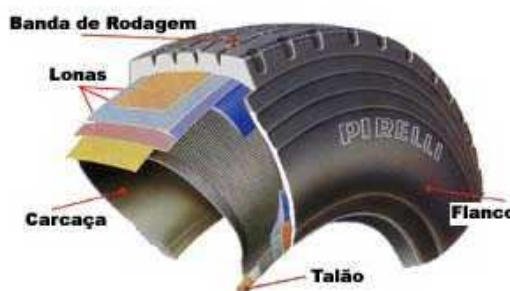
Figura 2: Esquema das camadas que compõe um pneu
