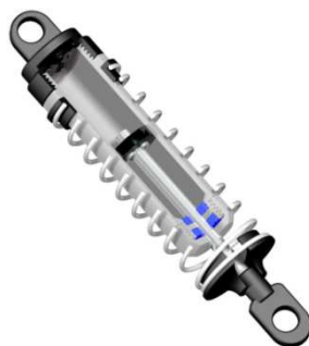
Figura 4: Desenho esquemático de um amortecedor
