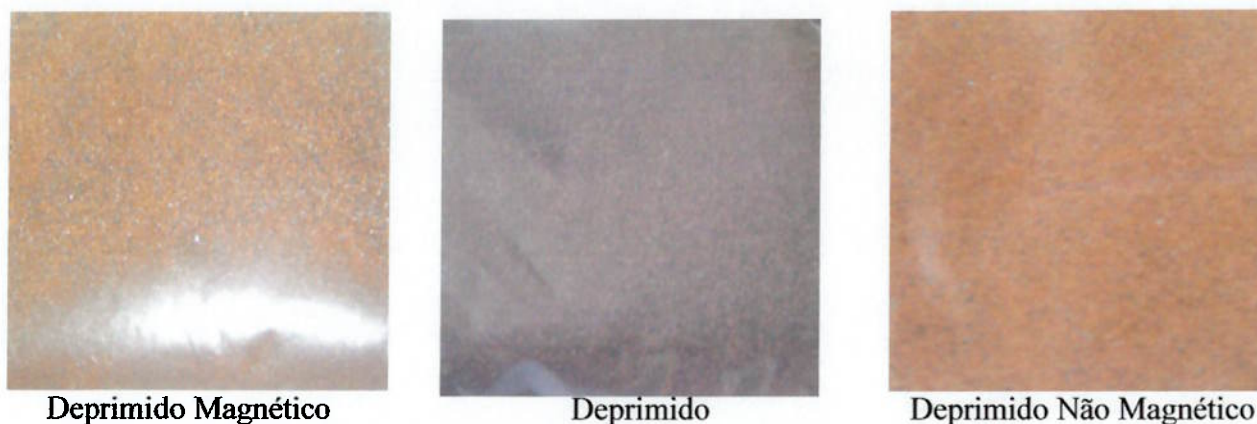
Figura 6.4. - Aparência física do deprimido do Deprimido Scavenger do ensaio 24 e o seu material magnético e não magnético.
