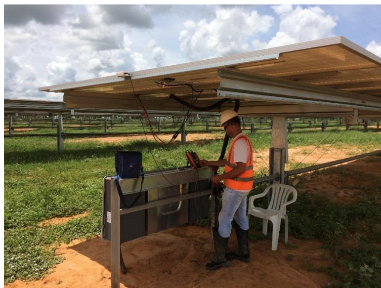
Figura 6: Execução do ensaio PVCHECKS no local.
