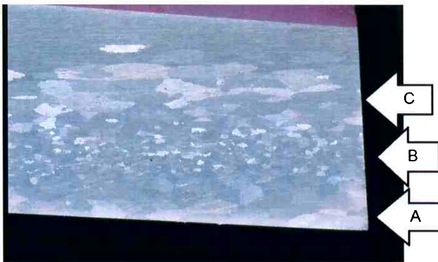
Figura 36: Detalhe da macrografia indicando as diferentes regiões com grãos grandes
