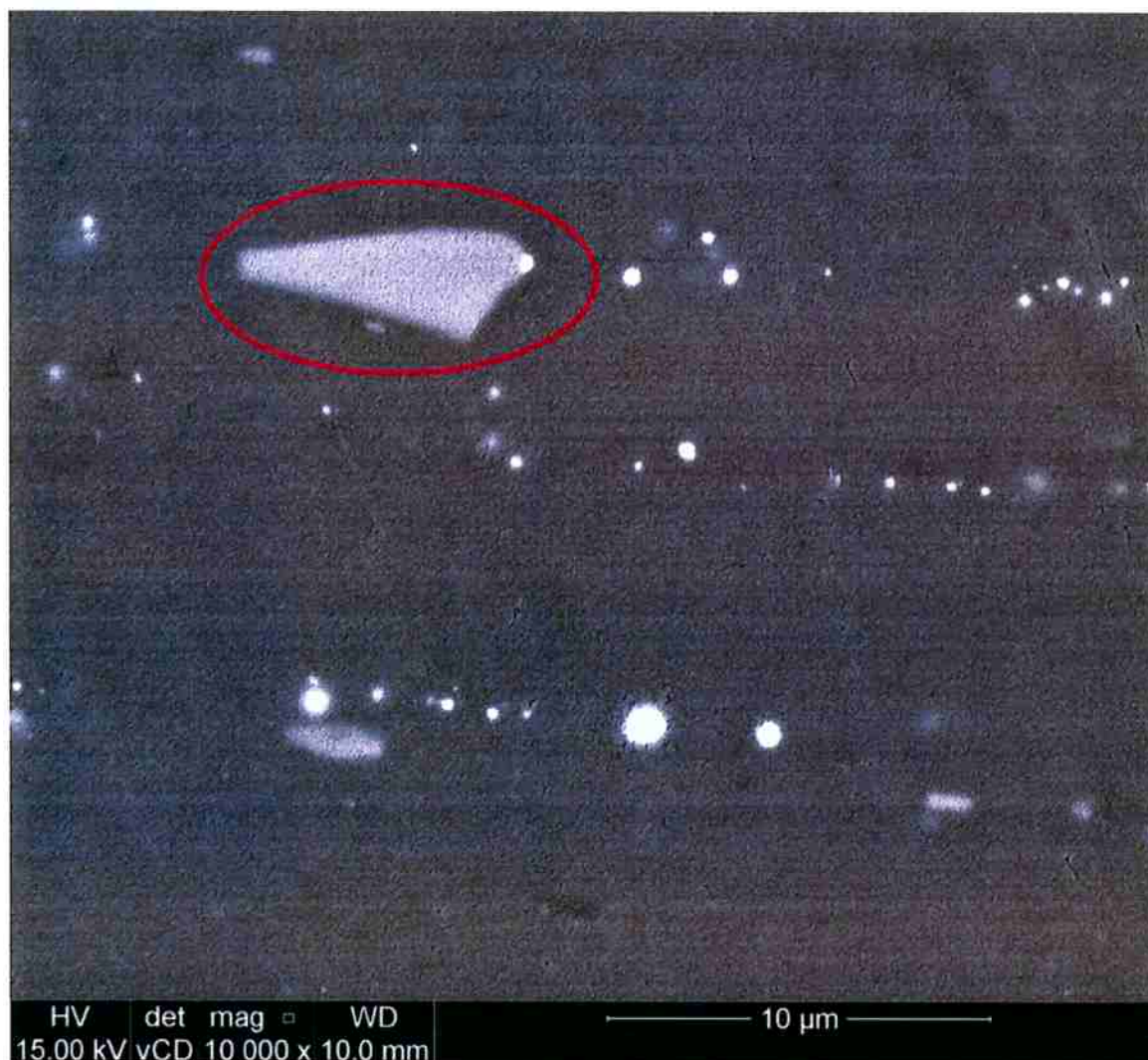
Figura 45: Imagem em microscopia eletrônica com precipitado de ferro e silício em destaque
