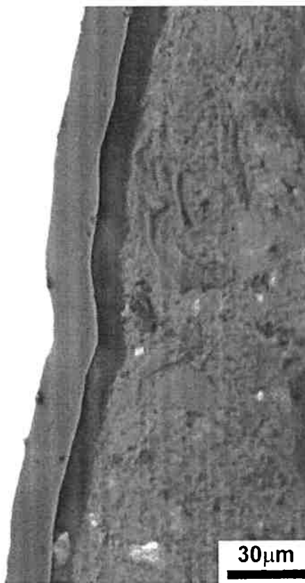
Figura 29: Imagem da camada anódica na face interna da amostra A, com espessura e estrutura uniformes
