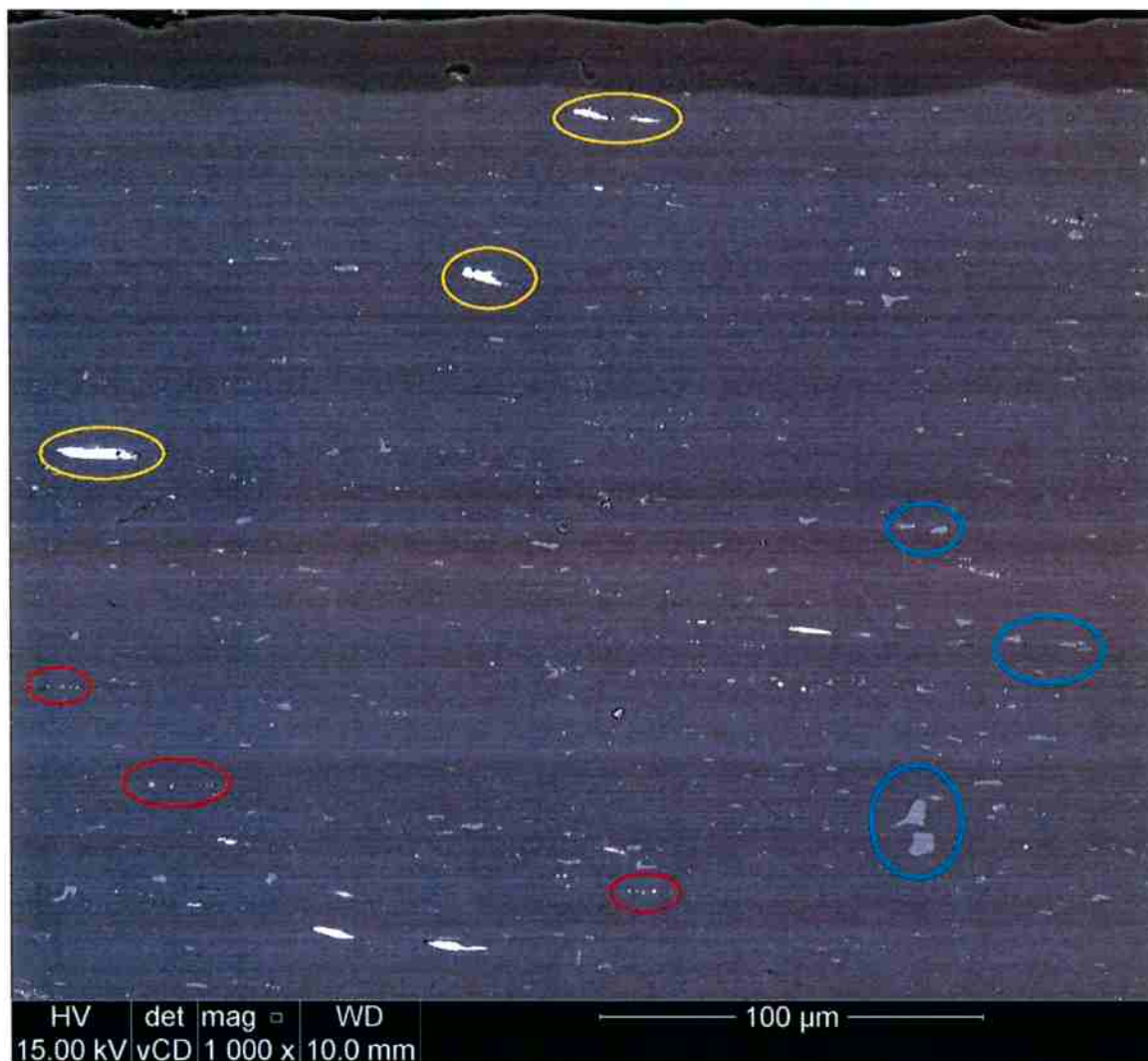
Figura 34: Imagem de microscopia eletrônica com destaque para exemplos de precipitados de bismuto (amarelo), chumbo (vermelho) e intermetálico Al-Fe (azul)
