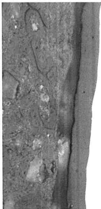
Figura 28: Imagem da camada anódica na face externa da amostra A, com espessura e estrutura uniformes
