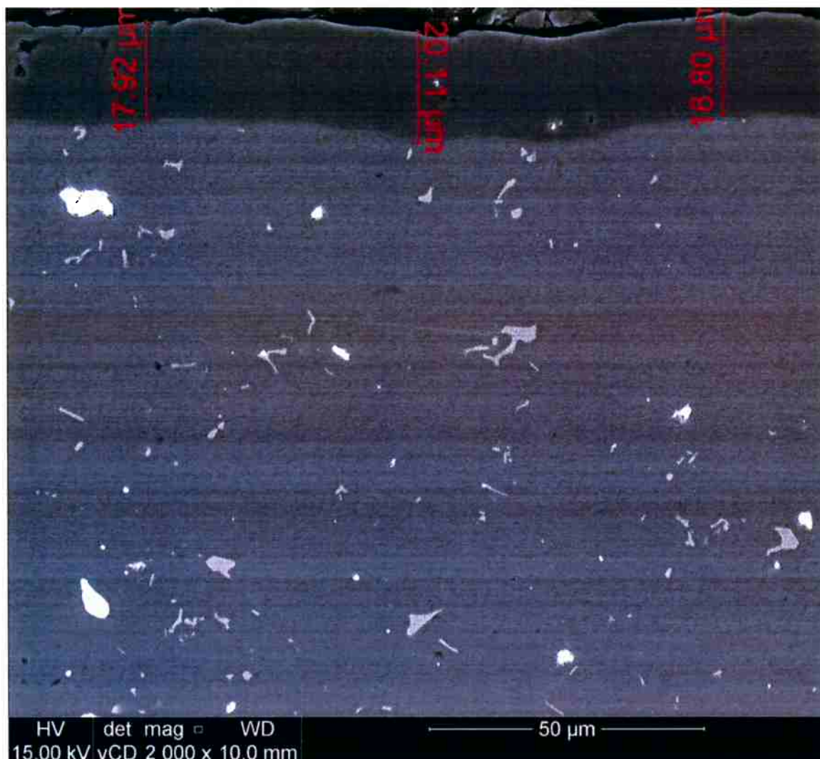
Figura 41: Imagem em microscopia eletrônica indicando a espessura da camada anódica na face externa próximo à base do copo
