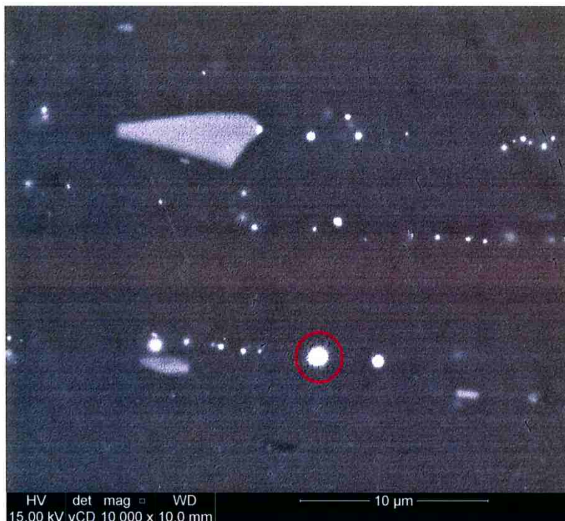
Figura 42: Imagem em microscopia eletrônica com precipitado de chumbo em destaque
