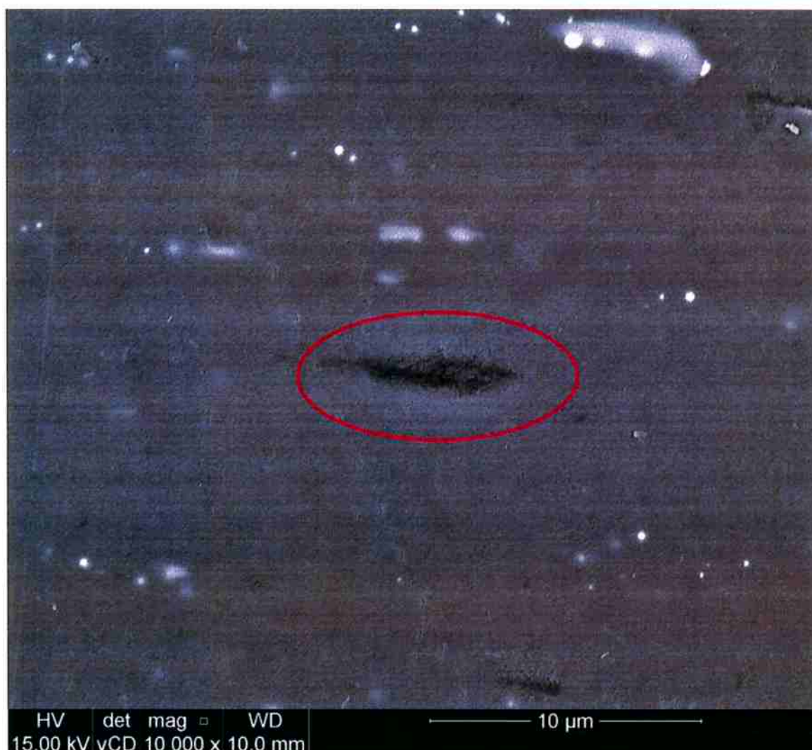
Figura 44: Imagem em microscópio eletrônico de precipitado de magnésio e silício (em destaque)
