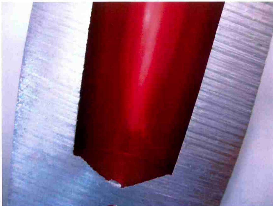
Figura 27: foto evidenciando a ausência de manchas observáveis à olho nu na base da cavidade interna da peça
