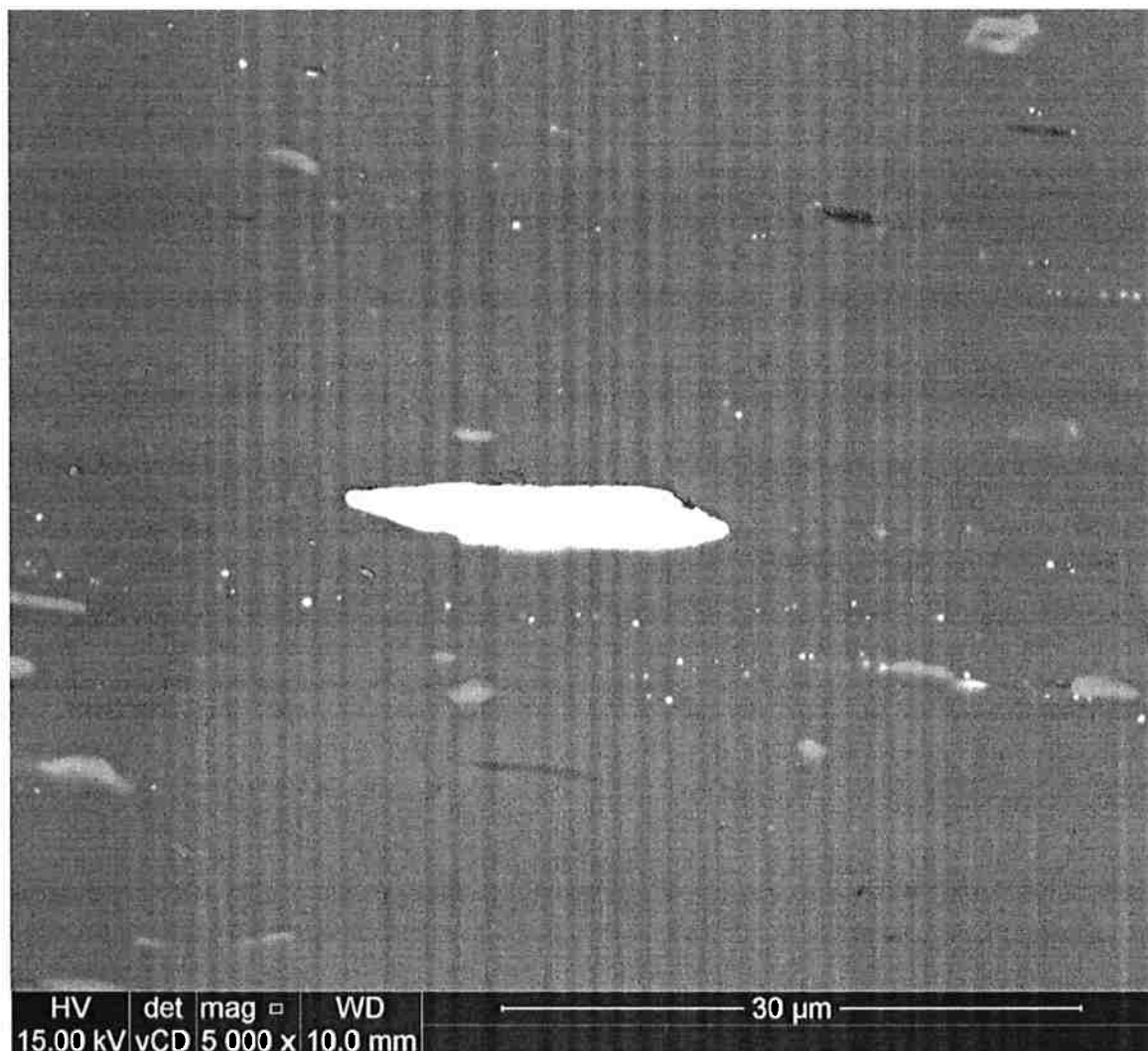
Figura 43: Imagem em microscópio eletrônico de precipitado composto majoritariamente por bismuto
