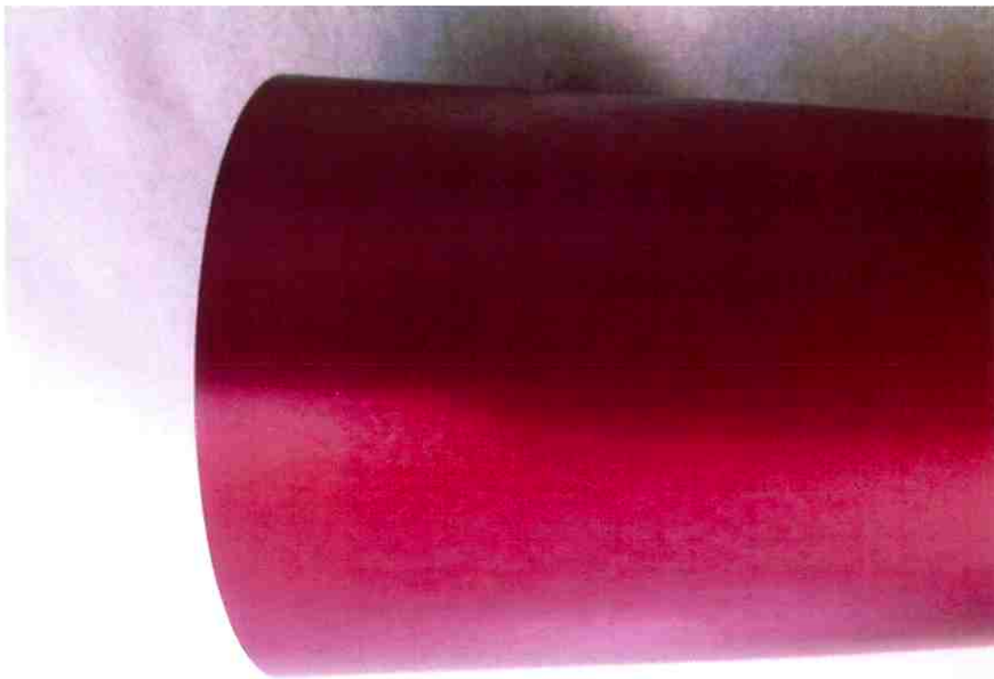
Figura 25: Foto evidenciando as manchas observadas na face externa do objeto de estudo
