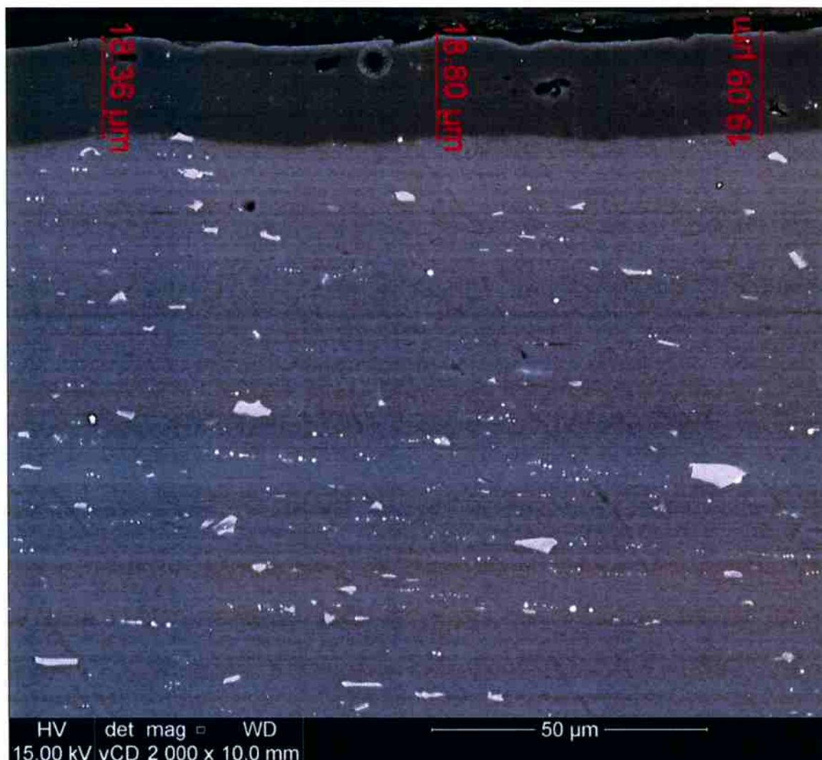
Figura 40: Imagem em microscopia eletrônica indicando a espessura da camada anódica na face externa próximo ao topo do copo
