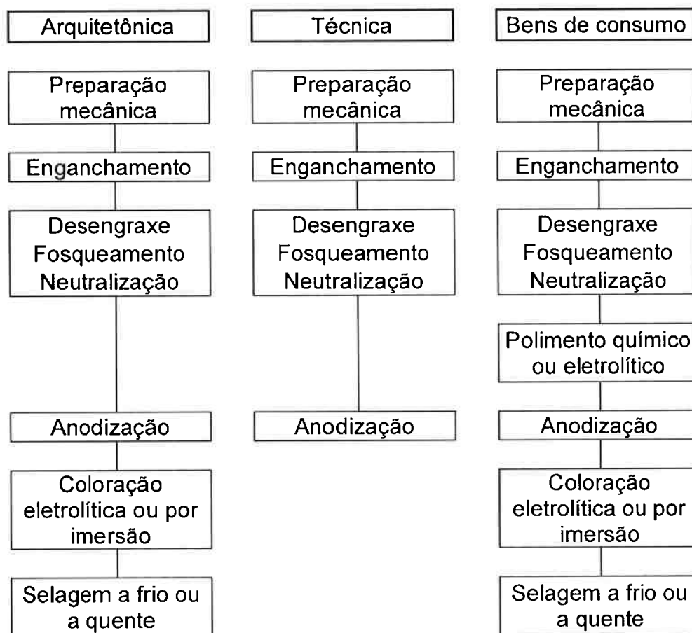
Figura 12: Fluxograma das etapas do processo de anodização
