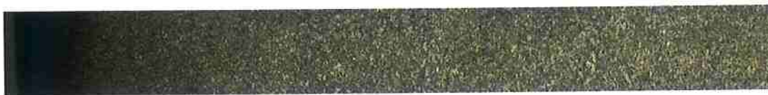
Figura 5. 2 Superfície nitretada da amostra desde a borda até o centro 50x. Solubilizado + ASPN.
