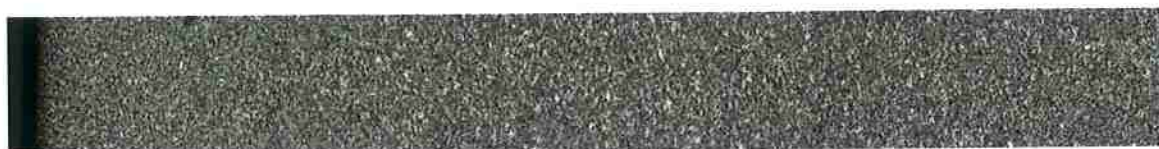
Figura 5. 14 Superfície nitretada da amostra desde a borda até o centro 50x. Partida Envelhecido + ASPN.
