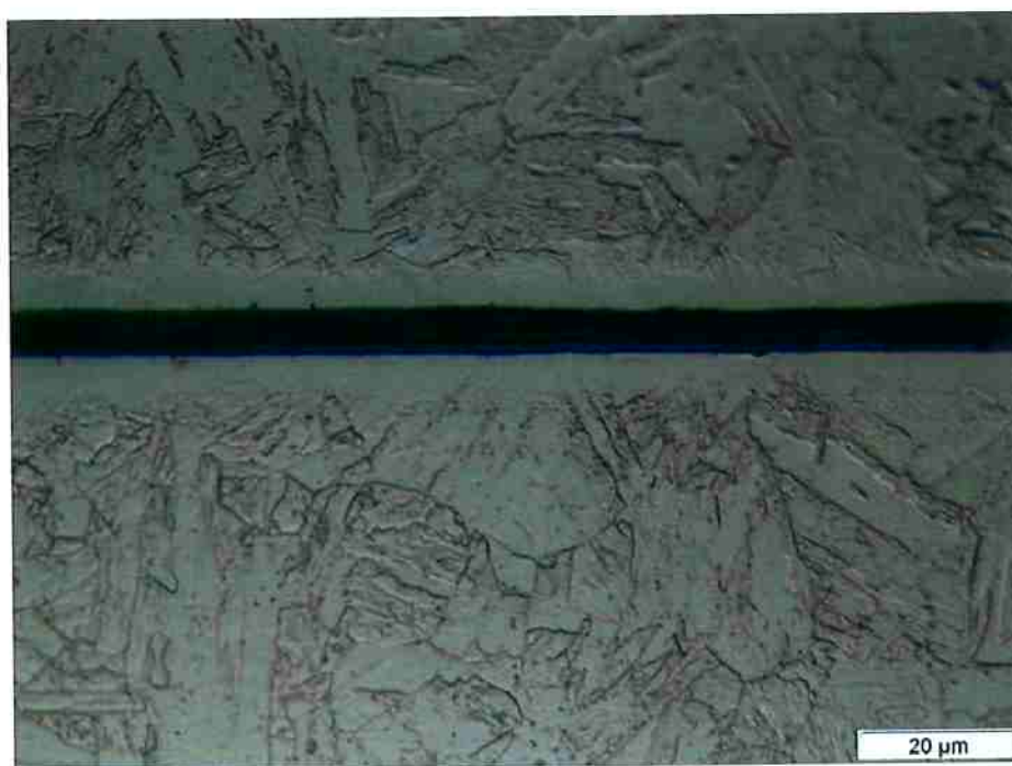
Figura 5. 3 Seção transversal do aço 17-4PH nitretado com tela ativa, previamente solubilizado 5.000X.
