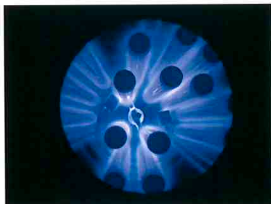
Figura 3. 6. Fotografia do interior de uma reator de Nitretação sob Plasma em funcionamento [15].
