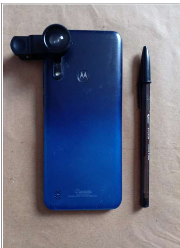
Figura 22. Smartphone Moto G8 Power Lite com lente “olho de peixe” apresilhada. Autoria: Cléia Campos, 2023.
