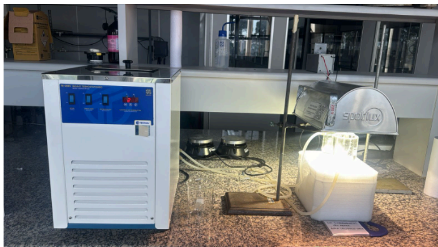
Figura 19 - Refletor de luz UV-vis utilizado na avaliação fotocatalítica da heterojunção.
