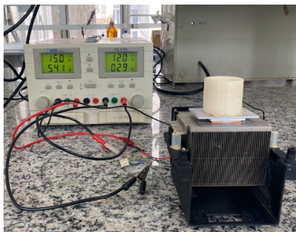
Figura 12 – Sistema Peltier utilizado para o congelamento da solução de PS-TiO 2 .
