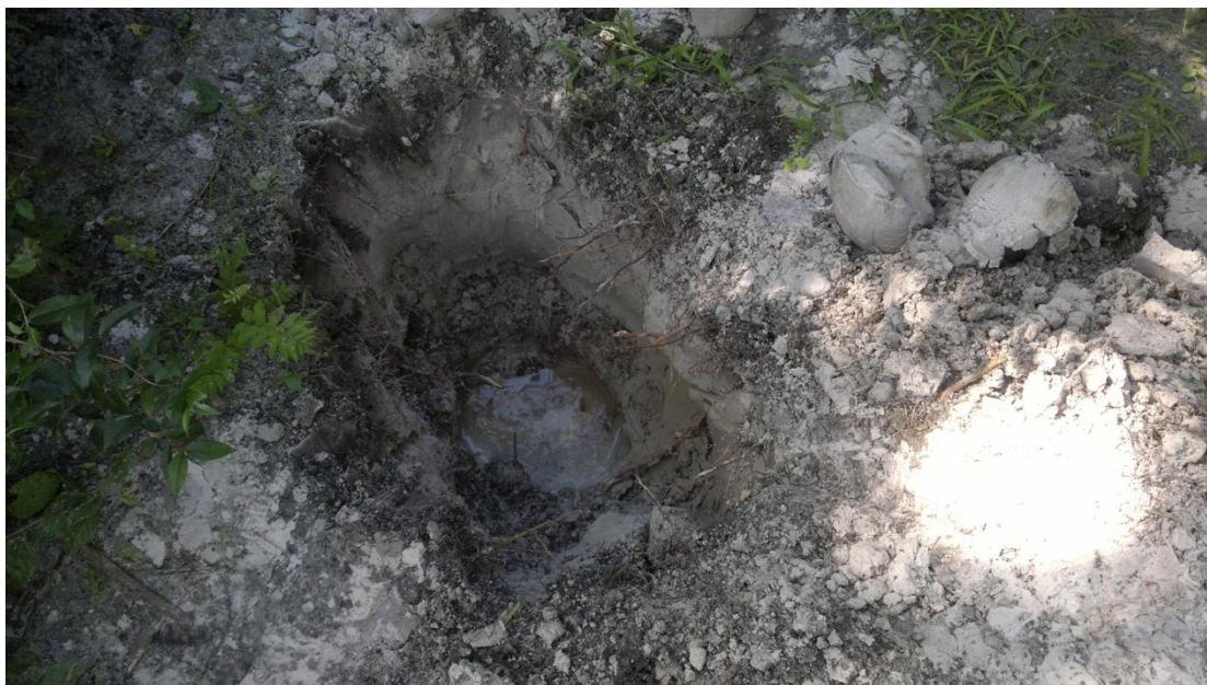
Figura 3-14 – Perfuração do solo para analisar a profundidade do nível d'água.
