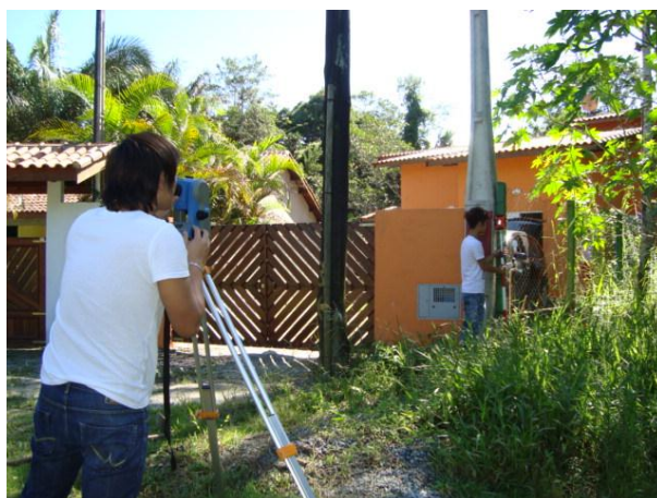
Figura 3-9 - Coleta de dados referente ao vértice da poligonal
