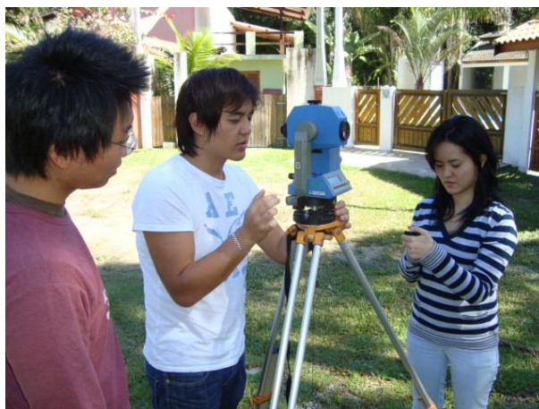
Figura 3-8 - Nivelamento da Estação Total
