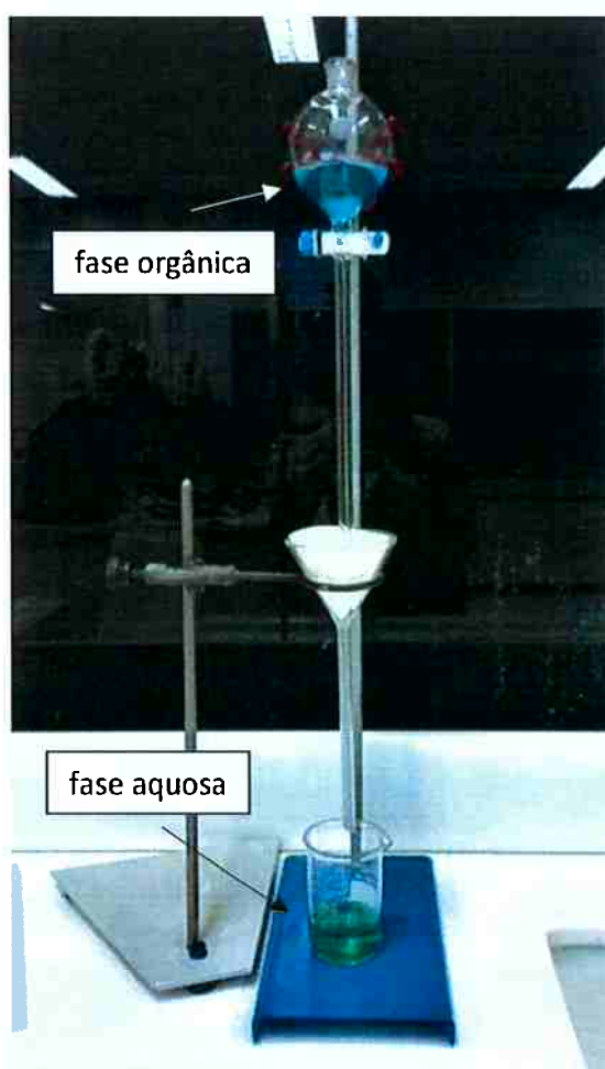
Figura 14: Aparatos utilizados para separação fase aquosa da orgânica após o processo de extração.
