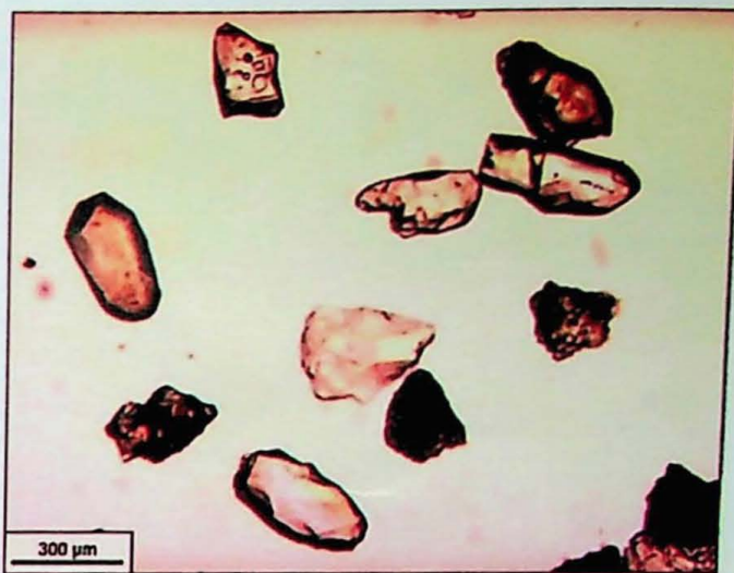
Amostra APAT, fração -0,149+0,074 mm, prod. não magnético -0,3 A – Partículas livres de apatita com superfície desde limpa e lisa, até fortemente impregnada e irregular.
