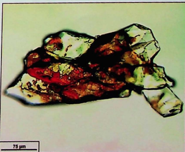
Amostra FST, fração -0,149+0,074 mm, prod. não magnético -0,3 A – Detalhe de película de óxi-hidróxidos de Fe (provavelmente goethita) recobrindo aglomerado de partículas de apatita com superfície lisa.
