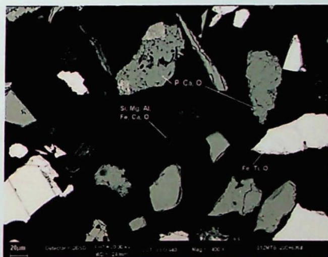
Amostra ZMT, fração -0,074+0,020 mm – Partículas de apatita liberada (cinza claro), ao lado de partículas de filossilicatos (cinza escuro) e titanomagnetita (branca).
