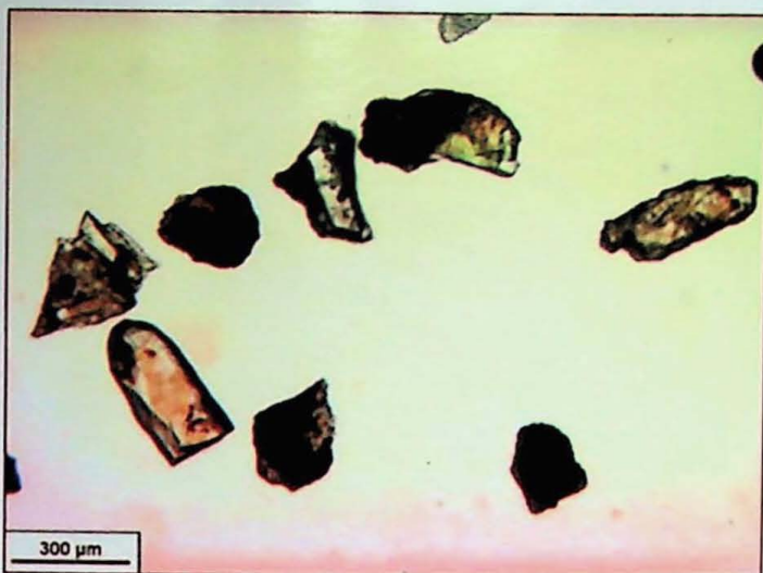
Amostra APAT, fração -0,149+0,074 mm, prod. não magnético -0,3 A – Partículas livres de apatita, com diferentes graus de recobrimento por películas de óxi-hidróxidos de Fe.
