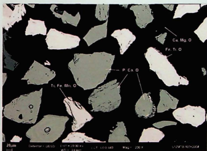
Amostra ZMT, fração -0,149+0,074 mm – Partículas liberadas de apatita (cinza claro), além de titanomagnetita (branca) e dolomita (cinza escuro).
