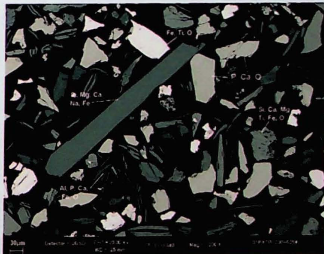
Amostra PXT, fração -0,074+0,020 mm – Aspecto geral. Partículas liberadas de apatita, oxihidróxidos de Fe, filossilicatos e piroxênio (partícula escura alongada).
