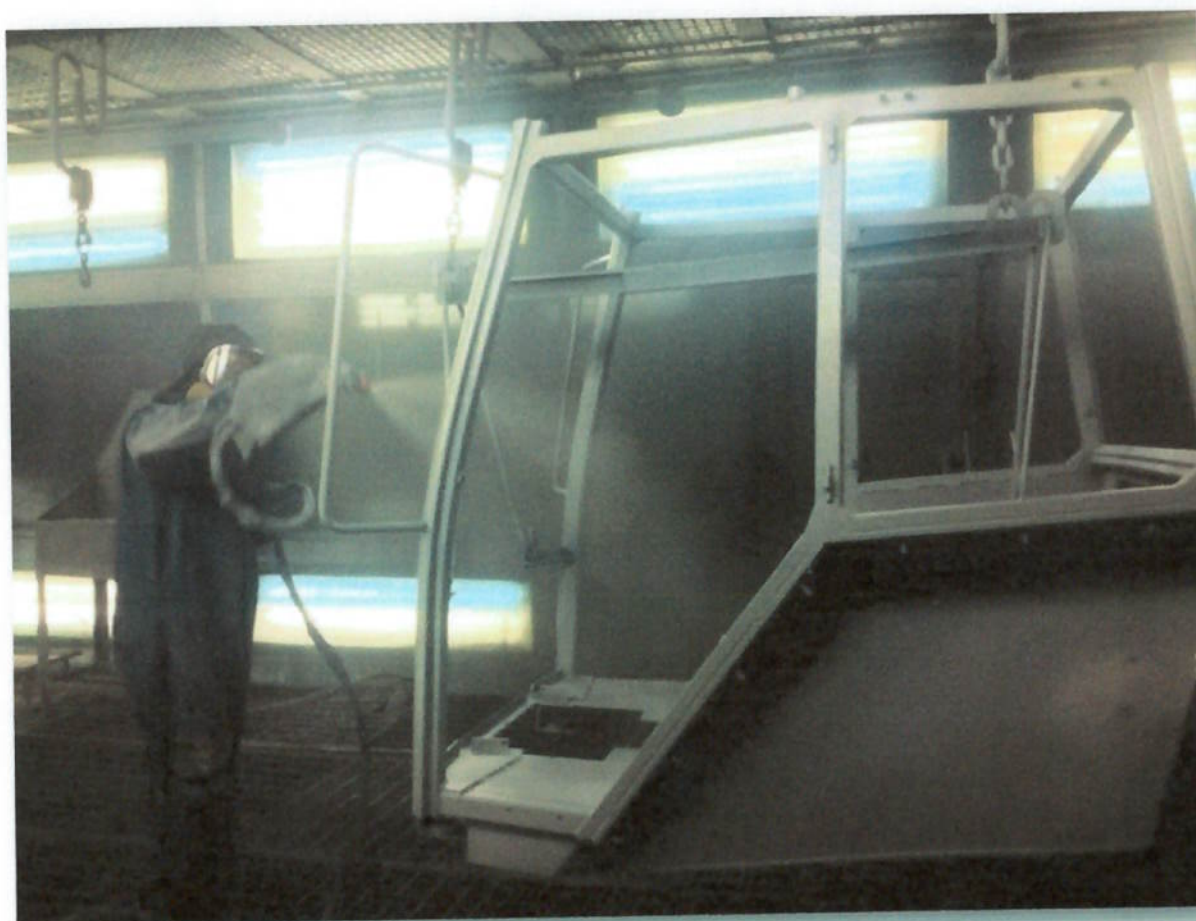
Figura 25 – Cabine de um trator da Linha Pesada recebendo uma camada de primer na Pintura de Componentes
