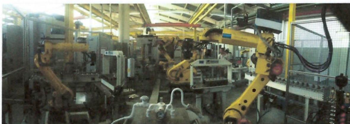
Figura 16 – Robôs FANUC realizando a montagem das sedes e guias dos motores AGCO Power
