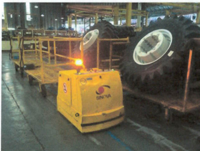
Figura 29 – O conjunto roda + pneu é transportado para a Linha de Montagem de Tratores por um sistema AGV ( Automated Guided Vehicle , em português, Veículo Guiado Automatizado)
