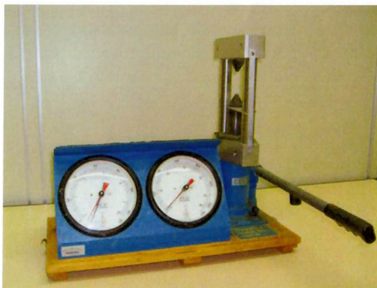
Figura 15 - Máquina para ensaios de compressão pontual
