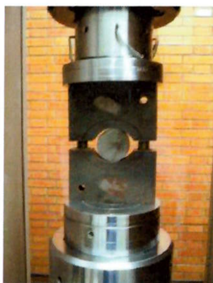
Figura 05 - Ensaio de tração pelo Método Brasileiro
