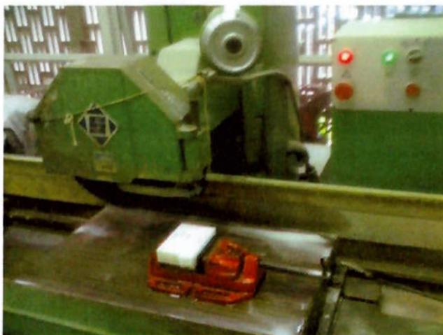
Figura 20 - Mármore sendo retificado
