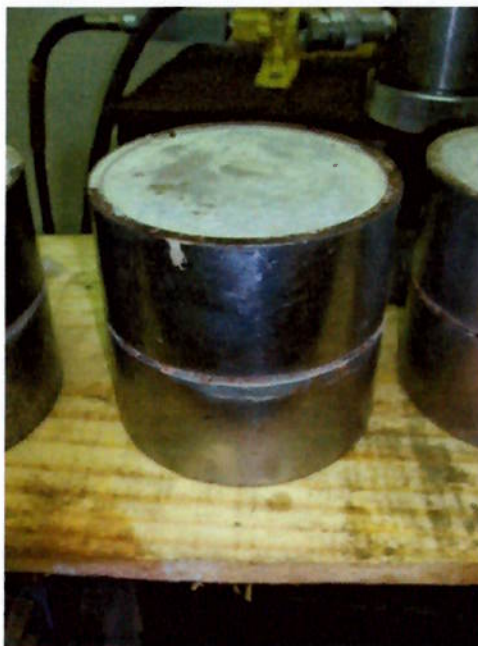
Figura 19 - Célula já concluída e pronta para o ensaio.
