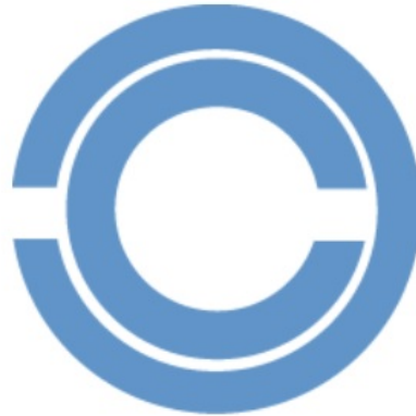
Figura 2: Modelo do um SRR apresentado por Pendry em 1999
