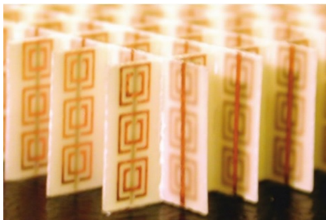
Figura 3: Foto do metamaterial LHM realizado por Smith et al [11].
