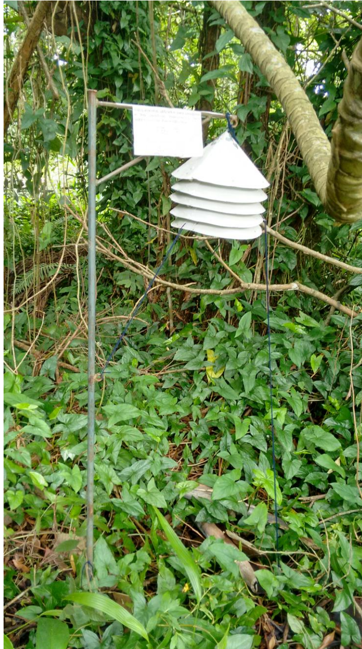
Figura 15: Mini abrigo com termo higrômetro instalado no ponto 1. Elaborado por Eulalya Ribeiro em 22/12/2015 às 9 hs.
