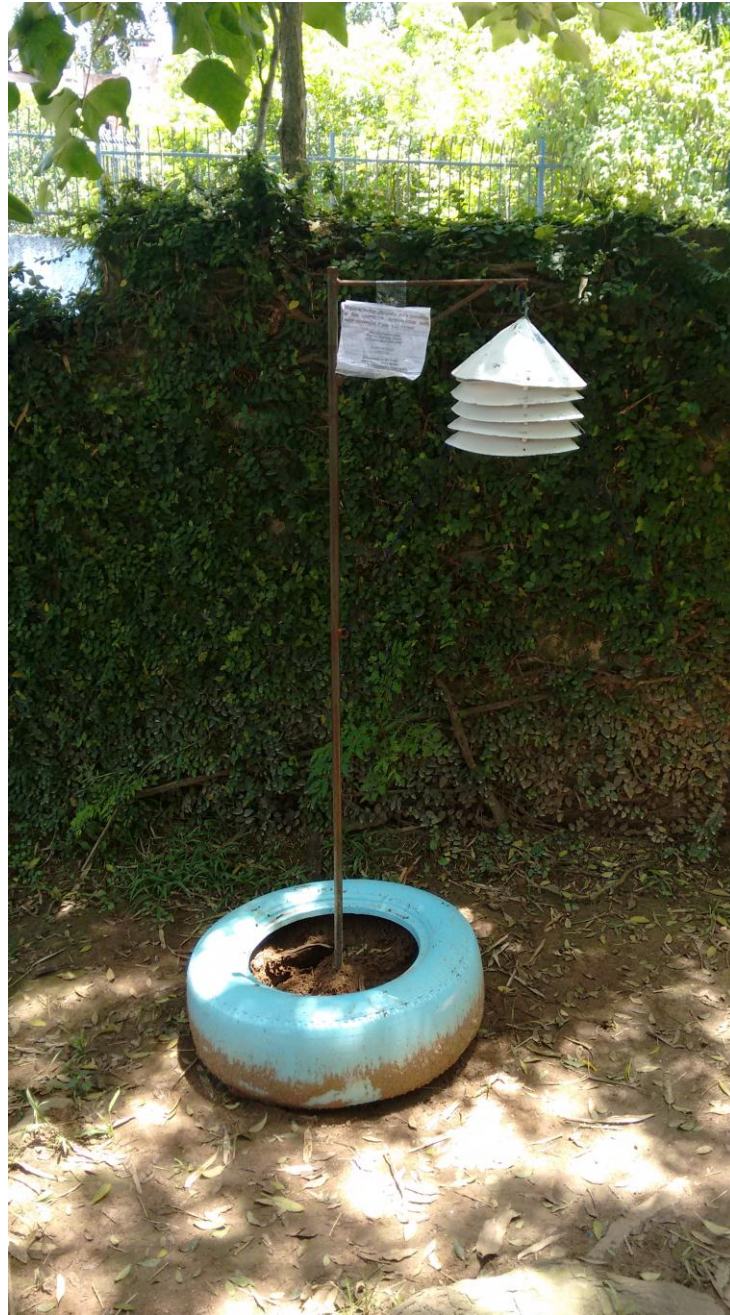
Figura 17: Mini abrigo com termo higrômetro no ponto 2. Elaborada por Eulalya Ribeiro em 22/12/2015 as 10hs.
