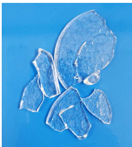
Figura 13. Vidro de diopsídio obtido após fusão e vertimento em gotas com splat cooling
