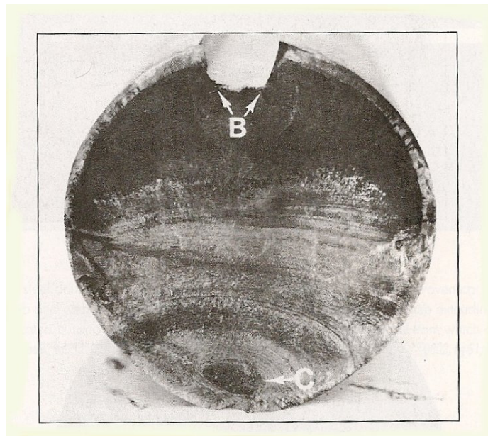
Figura 2.21 - Fratura a fadiga em um eixo, a fratura se iniciou no ponto B e progrediu até a ruptura final em C. A região de ruptura final é pequena, indicando que o carregamento era baixo. (SHIGLEY, 2004)
