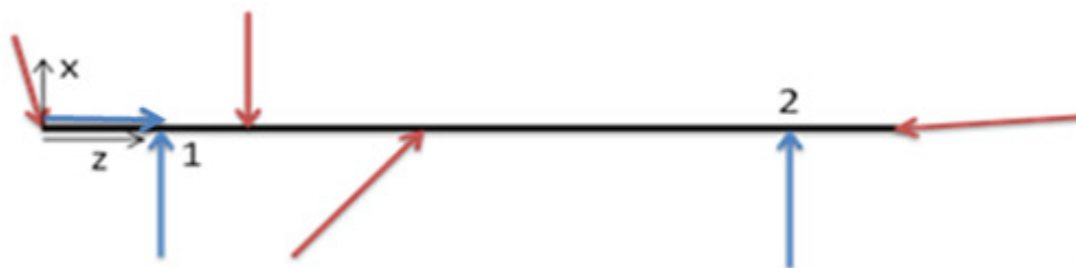
Figura 3.8 - Diagrama de corpo livre do eixo
