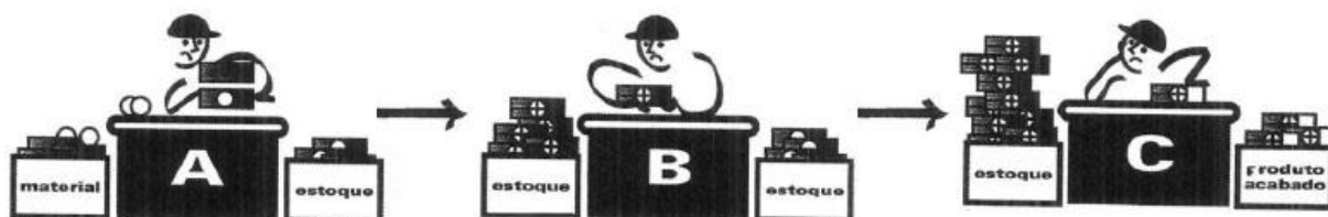
Figura 6 Fluxo convencional com formação de estoques intermediários
