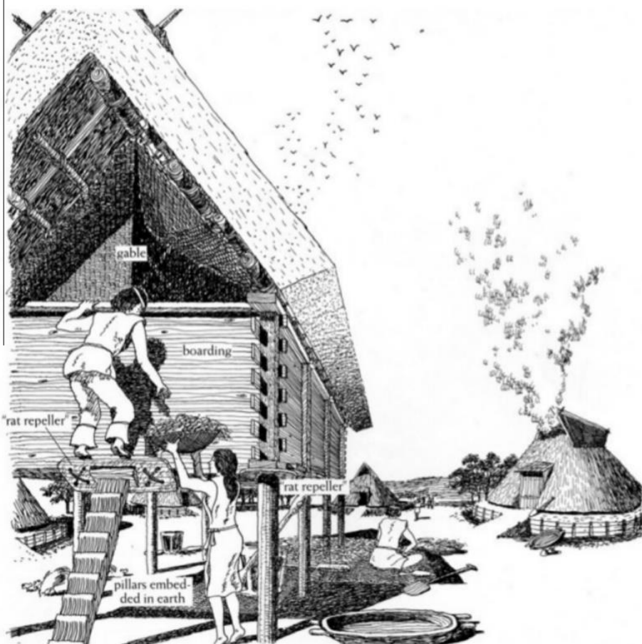
Exemplo de uma construção com piso elevado do período Yayoi. Fonte: Nakayama, 2000.P.20
