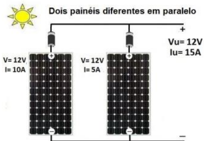
Figura 10 – Associação de Painéis Solares em Paralelo
