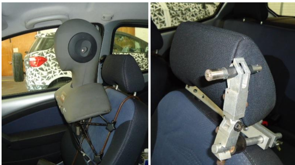
Figura 3.5 - Instrumentação utilizada para medição de ruído interno no veículo
