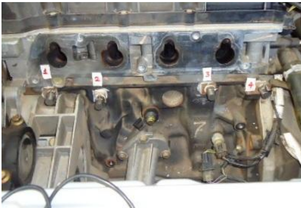
Figura 3.3 - Montagem dos acelerômetros para medição de vibrações no bloco do motor indicados com números de 1 a 4.
