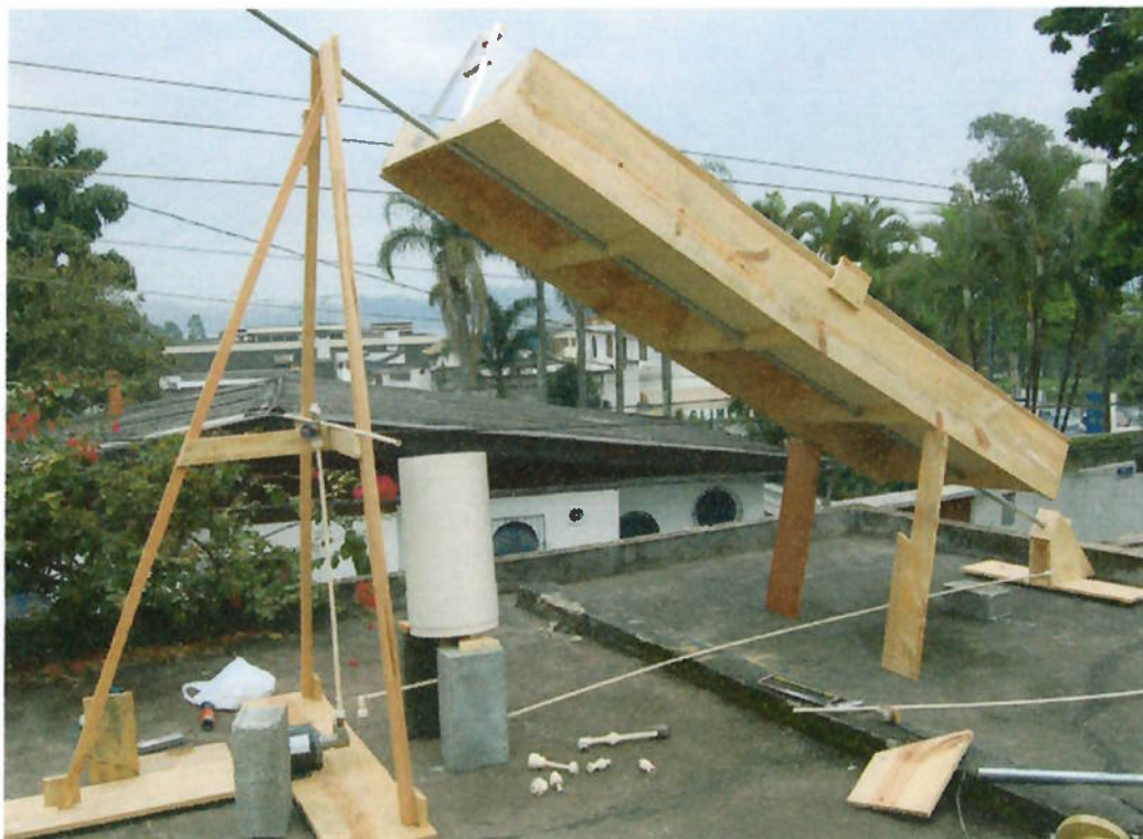
Figura 41 – Vista dos mancais durante a construção
