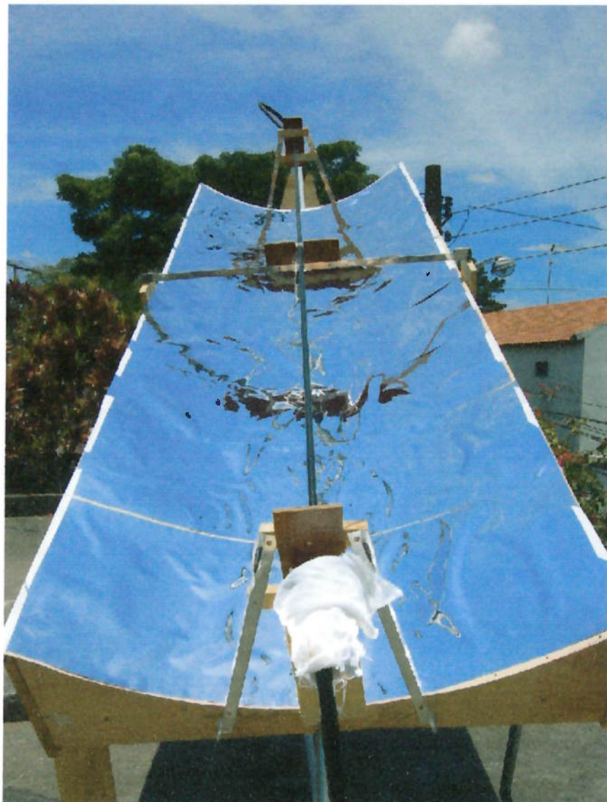
Figura 36 - Má conformação do filme reflexivo
