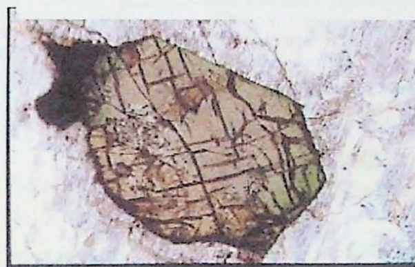
Fotomicrografia 3.7. Feldspato alcalino, onde podemos observar lamellas de exsolução. Lâmina IBL 15, nicóis cruzados. Base da imagem = 2,5 mm.
