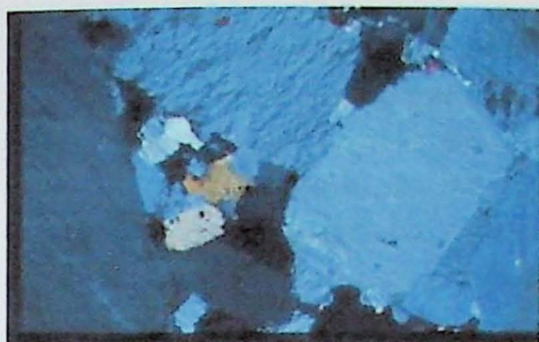
Fotomicrografia 3.7. Feldspato alcalino, onde podemos observar lamellas de exsolução. Lâmina IBL 15, nicóis cruzados. Base da imagem = 2,5 mm.
