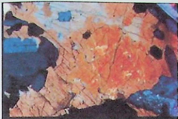
Fotomicrografia 3.1. Cristal de pirôxênio zonado, Lâmina IBL 04B, nicóis cruzados. Base da imagem = 2,5 mm.
