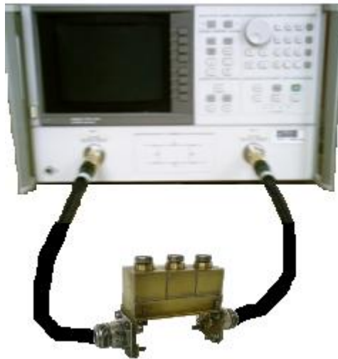
Figura 5.8 Configuração do Analisador de rede e o filtro para a análise experimental.
