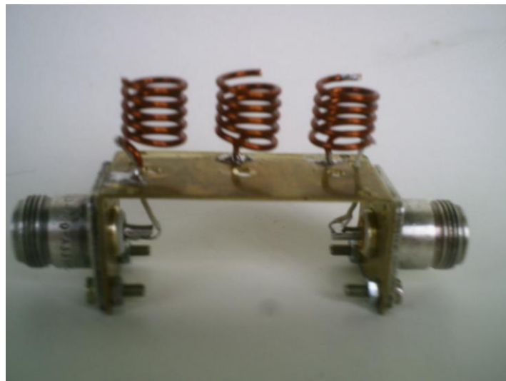
Figura 5.3 Tampa inferior removível do filtro 1, com os helicóides soldados e o com conectores tipo N .
