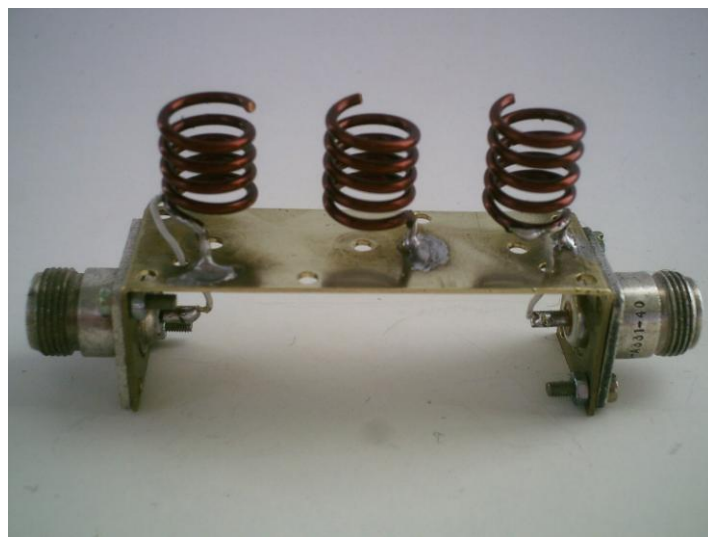
Figura 5.13 Tampa inferior removível do filtro2 , com as helicóides soldadas e o com conectores tipo N .
