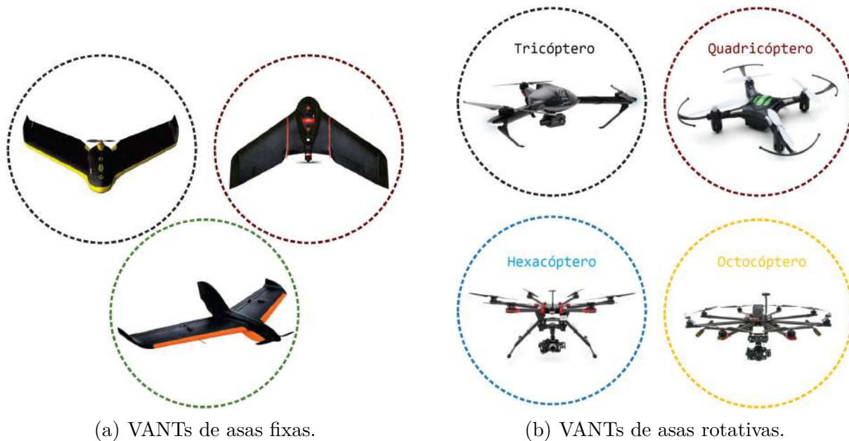
Figura 2 – Categorias de VANTs com relação à aerodinâmica.
