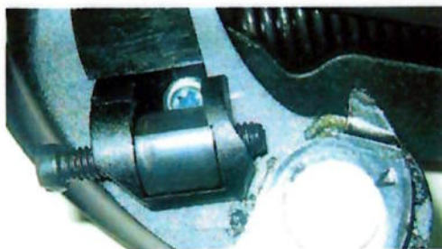
Figura 6 - Descarrilhador SunRace com medida corretiva
