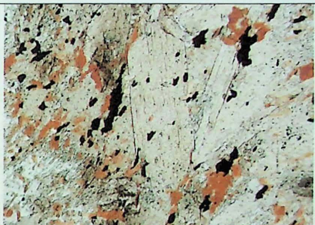
Foto 29 - Porfiroblasto de actinolita atribuído a metamorfismo de contato pela injeção de veio tonalítico em metabásica. Amostra 08 37, objetiva de 10 x, LT, N//.
