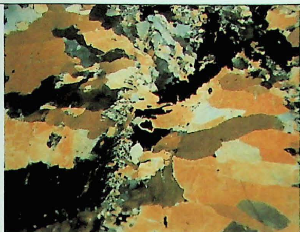
Foto 8 – Cristais de quartzo hipidiomórficos da primeira geração com textura de preenchimento hidrotermal. Amostra VL 02, objetiva de 1,6 x, LR, N//.
