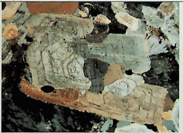
Foto 36 – Feldspato com textura glomero porfírica ao centro com formação de albita tardia cruzando a geminação e o zoneamento mineral dos cristais pretéritos de plagioclásio. Amostras VC – 03, objetiva de 5 x, LT, NX.
