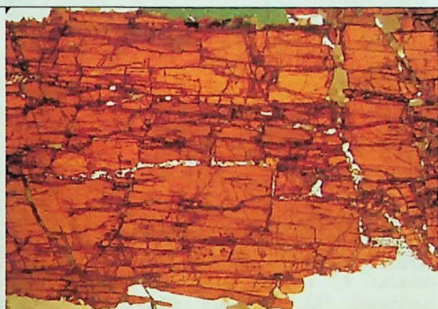
Foto 10 – Detalhe do preenchimento de fraturas em hübnerita por quartzo. Amostra VL – 19, objetiva de 1,8 x, LR, N//.
