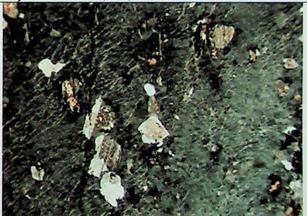
Foto 31 - Fenocristal poiquilítico de microclínio pertítico. Amostra SB - 08, objetiva de 5 x, LT, NX.
