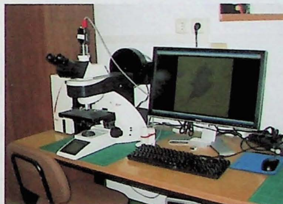
Fotos 1 e 2: Equipamento para análises de espectrais de reflectância em seções delgadas polidas.
