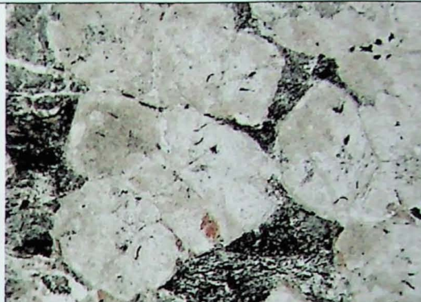
Foto 21 – Porfiroblastos de andaluzita formados por metamorfismo de contato, pós S2, em clorita-pirita-sericita-muscovita biotita ardósia com andaluzita pseudomorfizada. Amostra 08 23, objetiva de 5 x, LT, N//.
