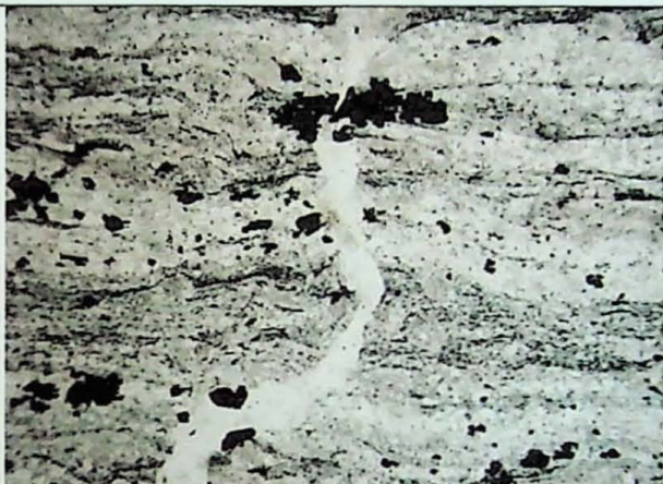
Foto 22 – Formação de veios de quartzo hidrotermal perpendiculares a foliação e, bandas de quartzo secundário concordantes a S1. Amostra MC – 05, objetiva de 2,5 x LT, N//.
