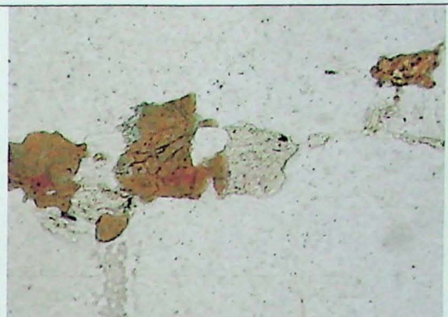
Foto 27 - Clorita intercrescida com biotita possivelmente formada por retrometamorfismo. Amostra 80 21, objetiva de 20 x. , LT, N//.
