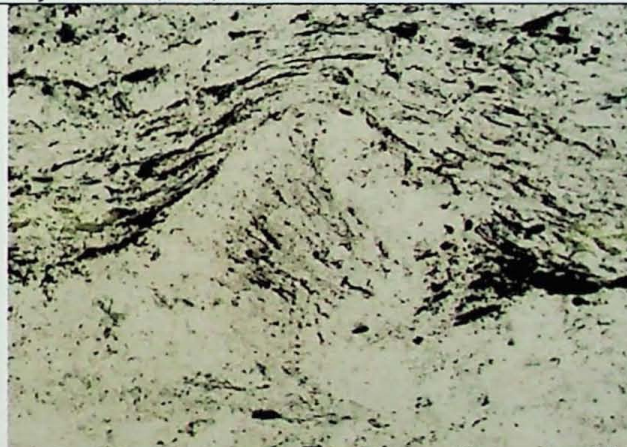
Foto 19 – Porfiroblasto de andaluzita. No detalhe podemos observar o amoldamento da matriz de muscovita, quartzo e opacos. Amostra MC – 05, objetiva de 20 x ,LT, N//.
