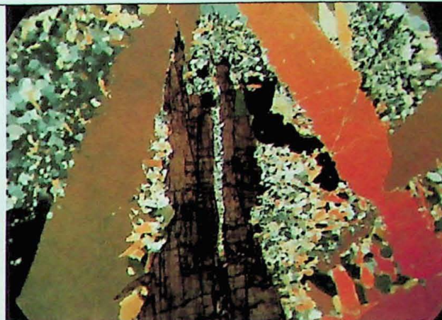
Foto 9 – Cristais de quartzo e hübnerita hidiomórficos da primeira geração em matriz de quartzo associada segunda geração. Notar preenchimento de fratura de hübnerita por quartzo. Amostra CU – 17, objetiva de 2,5 x, LR, N//.
