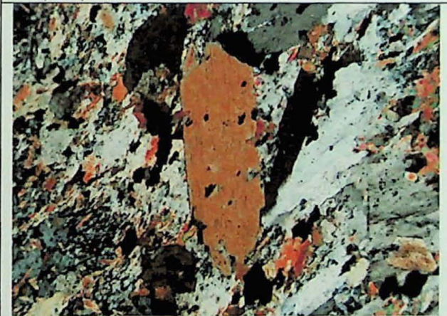
Foto 30 - Detalhe do porfiroblasto de actinolita com polarizadores cruzados. Amostra 08 37, objetiva de 10 x, LT.
