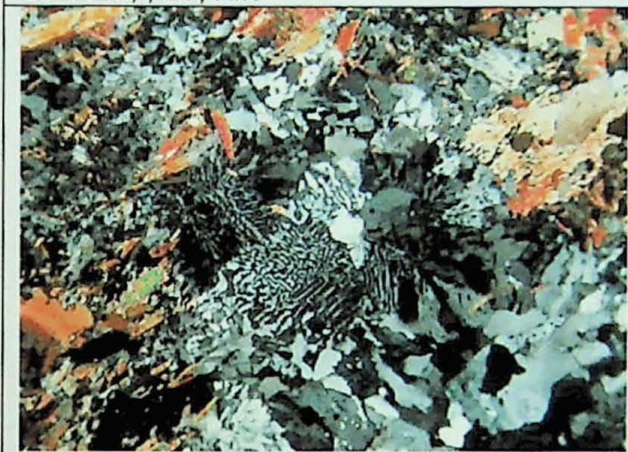
Foto 28 - Formação de mirmekitas no contato entre veio tonalítico e andaluzita muscovita ardósia. Amostra 08 37, objetiva de 5 x, LT, NX
