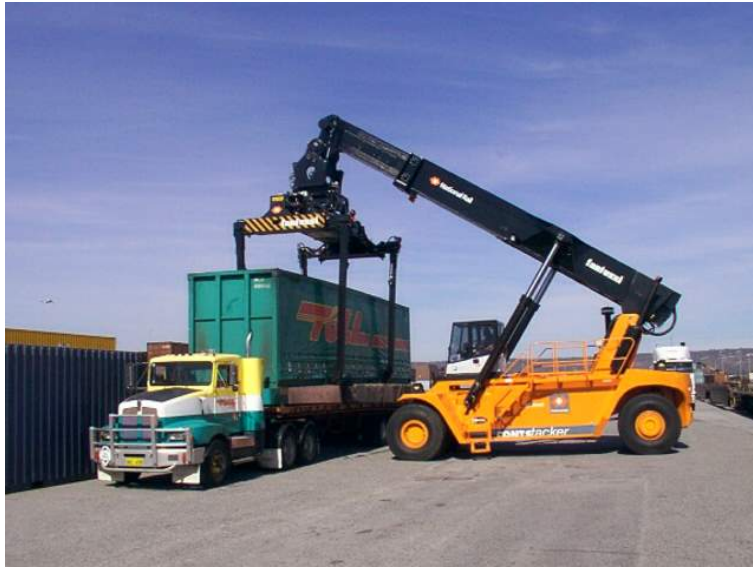
Figura 32 – Exemplo de operação de descarga com um reach stacker
