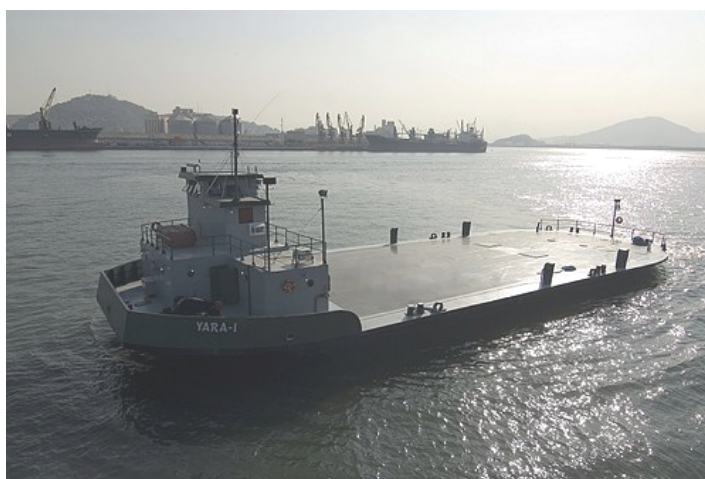
Figura 27 – Barcaça-tipo, com capacidade para 32 contêineres
